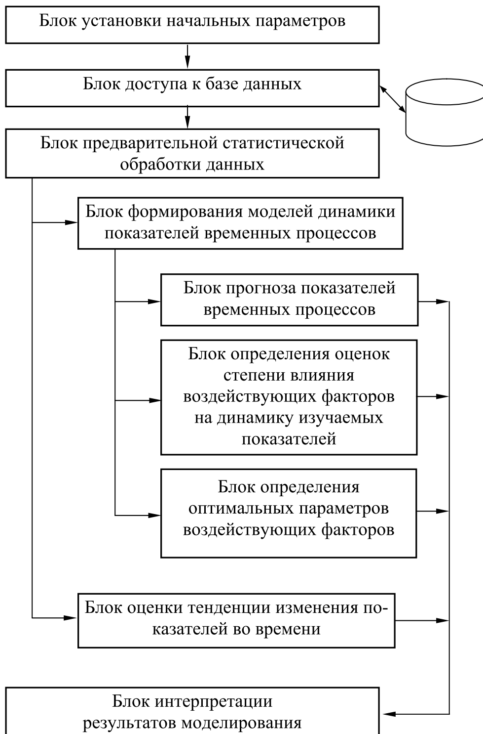
Рис. 3.7. Структура подсистемы «Прогноз» информационной системы прогнозирования и анализа временных процессов
