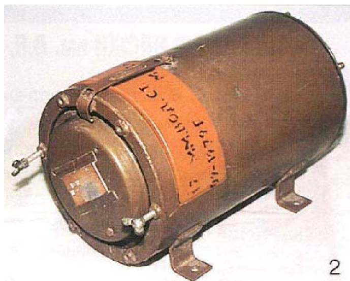
Рис. 8. Фильтровентиляционная установка ФВУ-20
