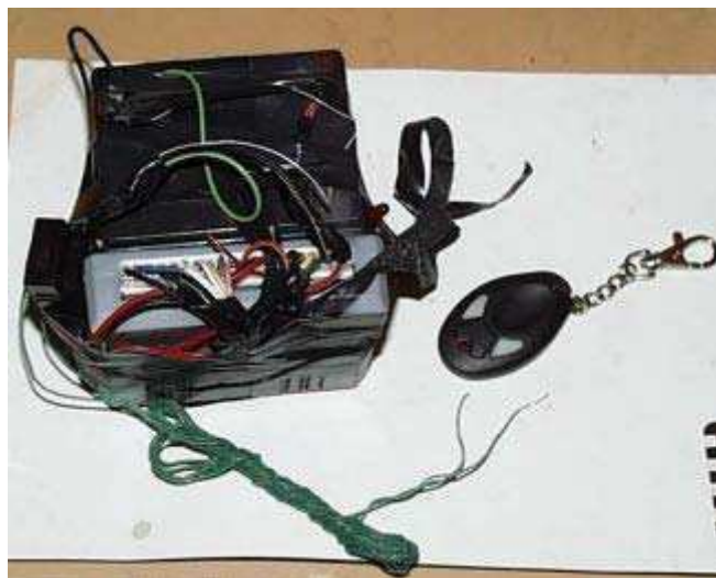
Устройство управления подрывом СВУ – автомобильная сигнализация
