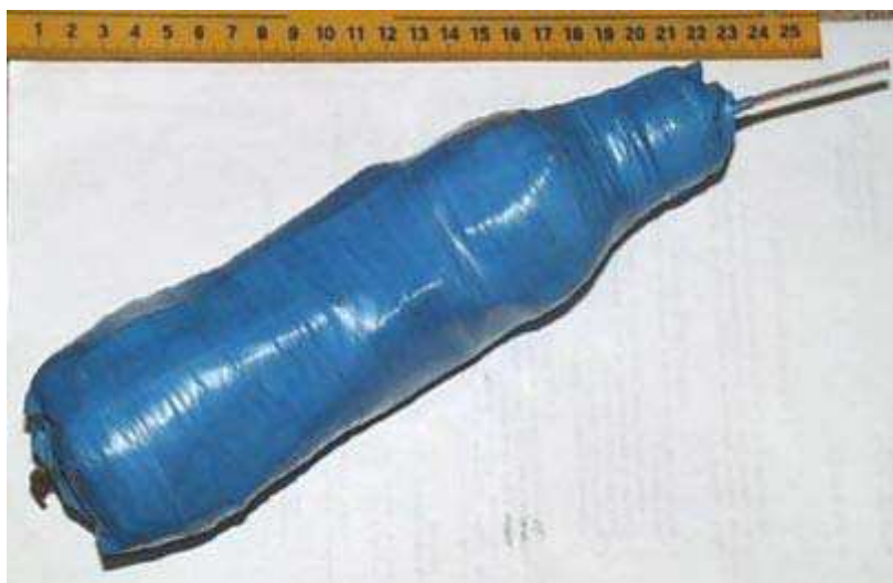
СВУ в пластиковой бутылке с фитилем, заряд ПТС
