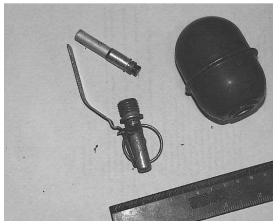
Граната РГД-5 с взрывателем УЗРГМ-2 (запал вывинчен из корпуса взрывателя)
