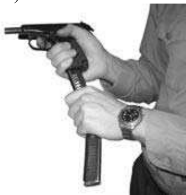
Рис. 74. Извлечение неисправного магазина из основания рукоятки
