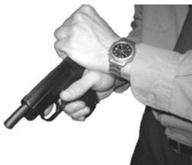
Рис. 20. Проверка наличия патрона в патроннике
