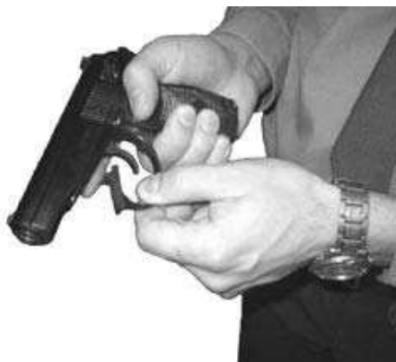
Рис. 21. Установка спусковой скобы в перекошенное положение
