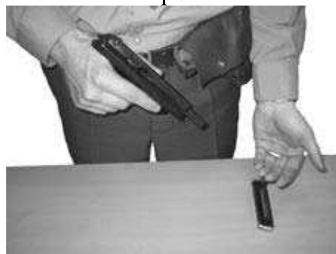
Рис. 90. Извлечение патрона из патронника
