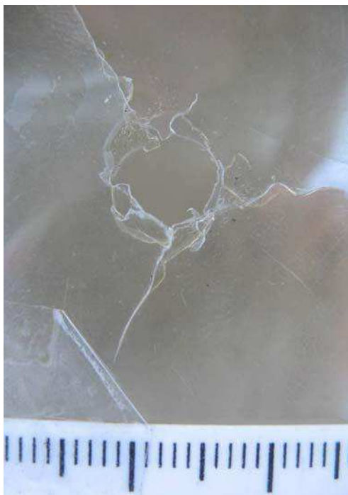
Иллюстрация №25. Механическое повреждение лобового стекла автомашины ДПС г/н А 0190 57 RUS(вид со стороны капота).
