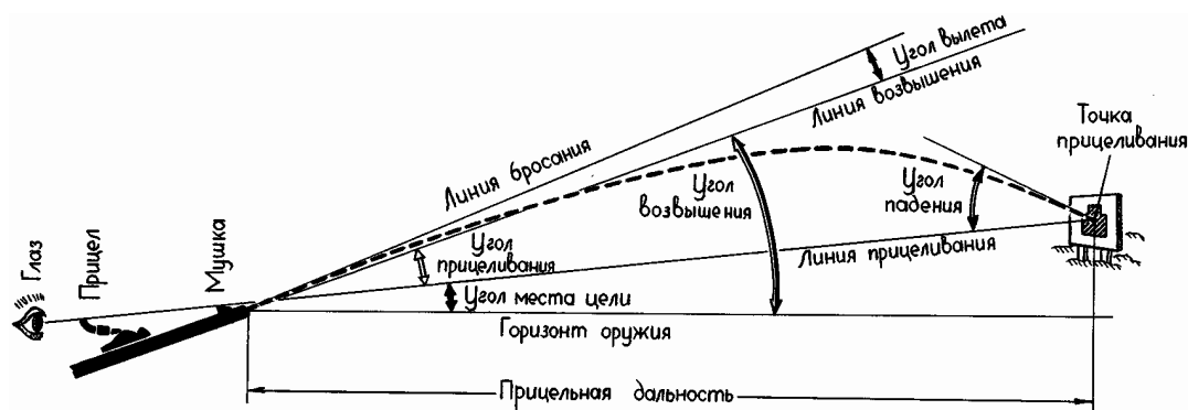
Рис. 79. Элементы наводки оружия в цель.
