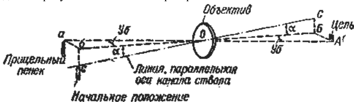
Рис. 80. Прицеливание (наводка) с помощью оптического прицела.
