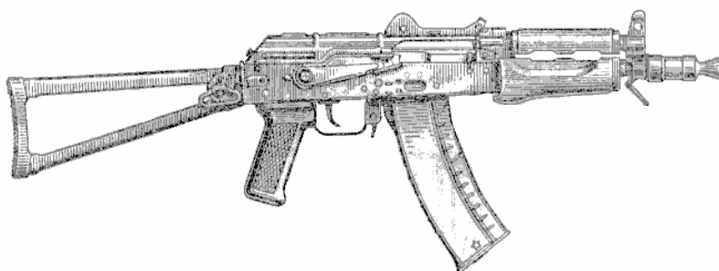
Рис. 111. 5,45-мм автомат Калашникова со складывающимся прикладом обр. 1974 г. с укороченным стволом (АКС - 74У)
