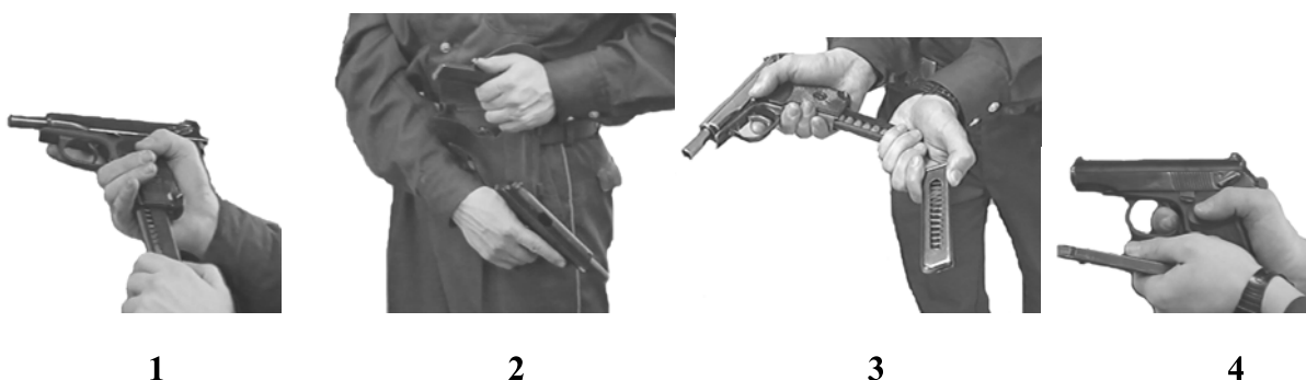
Рис. 192. Порядок смены магазина, начиная с извлечения пустого магазина
