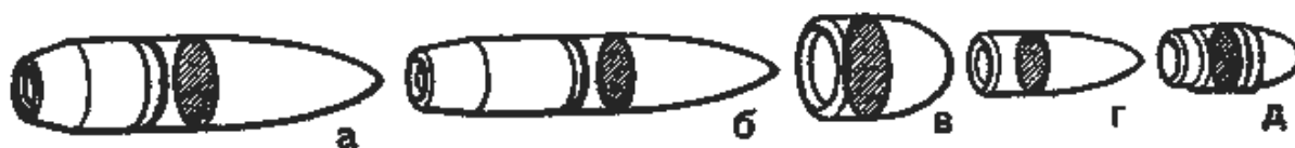
Рис. 83. Площадь поперечного сечения пули: а – к 7,62-мм АКМ; б – 5,45-мм АК – 74; в – к 9-мм ПМ; г – к 5,45-мм ПСМ; д – к 5,6-мм спортивному пистолету (длинный патрон).
