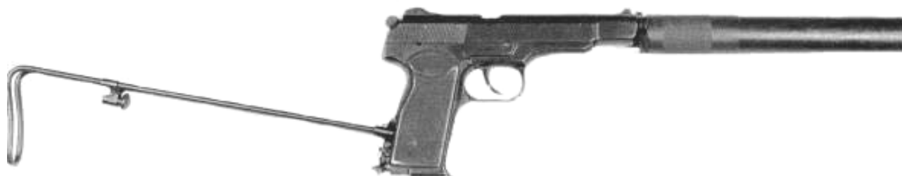
Рис. 39. АПСБ с присоединенным проволочным прикладом и глушителем.
