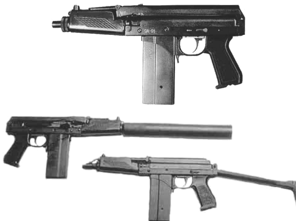
Рис. 8. Автомат 9А-91 (в походном положении, с глушителем, с разомкнутым прикладом).
