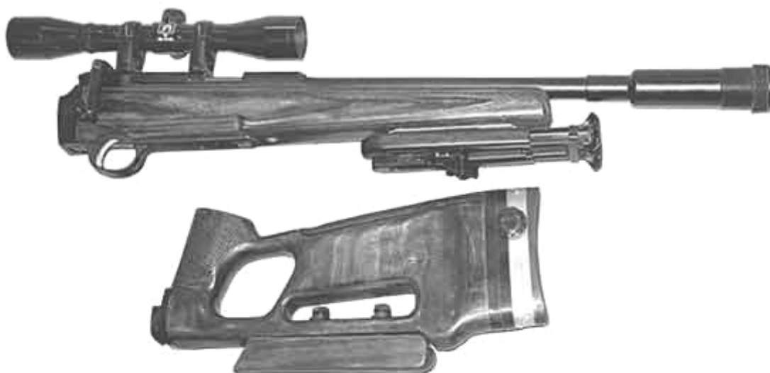
Рис. 22. Малокалиберная снайперская винтовка СВ-99 в разобранном виде.
