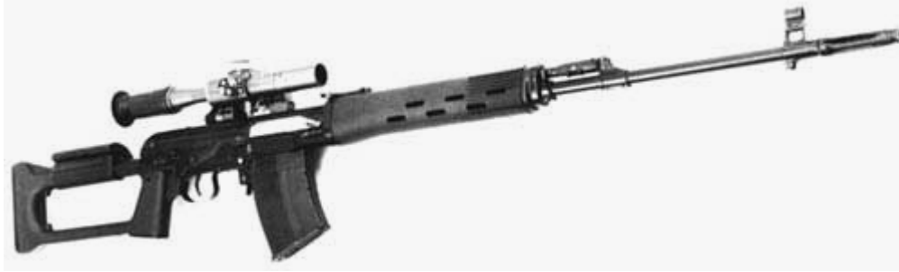
Рис. 19. СВД, новая модель: пластмассовый не складывающийся приклад, пластмассовые накладки, опытный 10-зарядный магазин.
