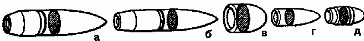
Рис. 31. Площадь поперечного сечения пули: а – к 7,62-мм АКМ; б – 5,45-мм АК – 74; в – к 9-мм ПМ; г – к 5,45-мм ПСМ; д – к 5,6-мм спортивному пистолету (длинный патрон).
