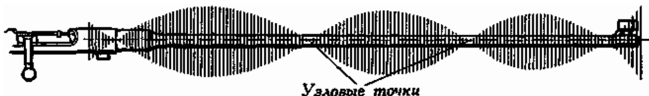
Рис. 9. Схематическое изображение вибрации ствола при выстреле.
