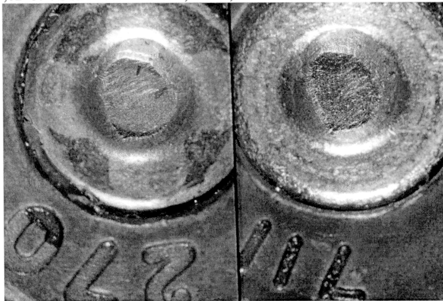
Иллюстрации №№ 8-9. Иллюстрации совпадающих частных признаков одной из гильз, изъятой с места происшества и одной из экспериментальных гильз, стреляных в карабине «ОП СКС» калибра 7,62×39 № ПЯ 2015 «Сайга 7,62-01»,
