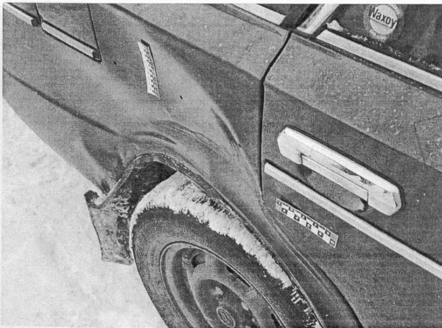
Решо №2. Металлические повреждения заднего пробоя крестов автомашины ВАЗ-2106 гос. № Н 747 НА 57/рчс.
