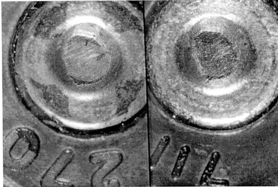
Иллюстрации №№ 8-9. Иллюстрации совпадающих частных признаков одной из гильз, изъятой с места происшества и одной из экспериментальных гильз, стреляных в карабине «ОП СКС» калибра 7,62×39 № ПЯ 2015 «Сайга 7,62-01»,
