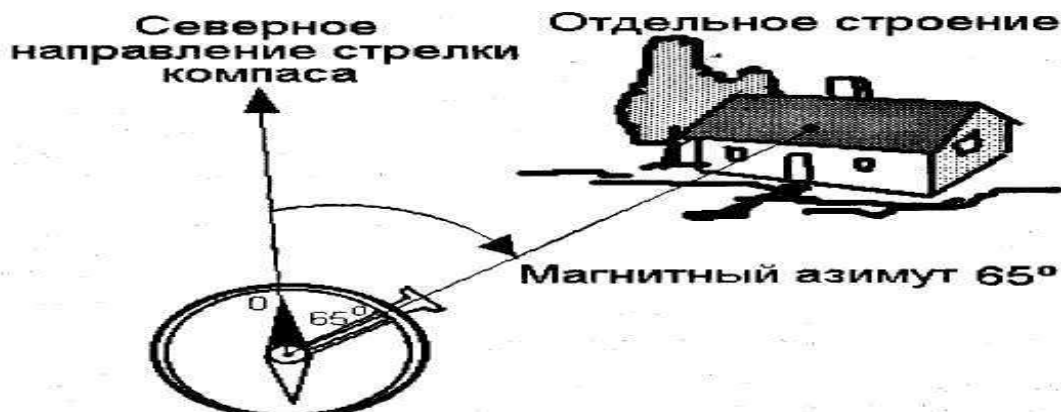
Рис. 15. Определение магнитного азимута
