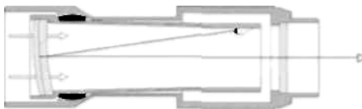
Рис. 12. Принцип работы коллиматорного прицела: красный свет от светодиода отражается назад от передней линзы (двойная линза), весь остальной свет проходит свободно (практически без отражений).
