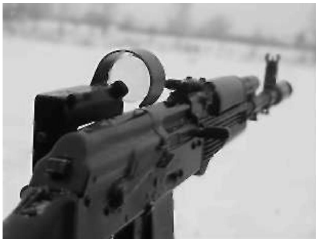
Рис. 15. Коллиматорный прицел открытого типа (ОКП «Оса»), установленный на автомате АК-74Н.
