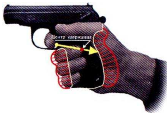
Рис.7. Распределения усилия по рукоятке
