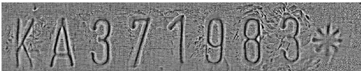
Фото 5. Магнитооптическая визуализация магнитограммы фрагмента VIN, изменённого методом «зачеканивания» элементов знаков.
