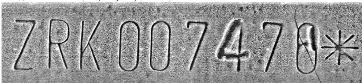
Фото 4. Магнитооптическая визуализация магнитограммы фрагмента VIN, изменённого методом заливки легкоплавким металлом элементов знаков.
