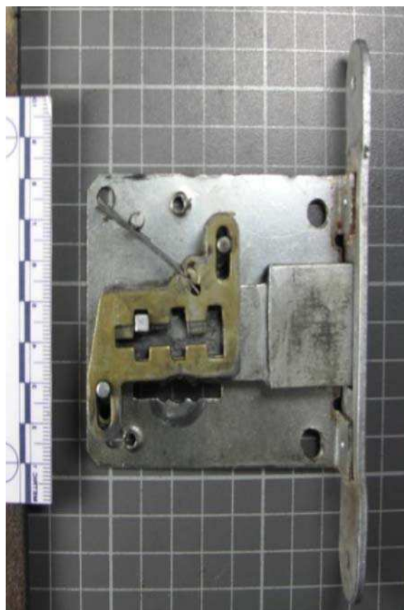
Ил. 6. Вид замка со снятой крышкой
