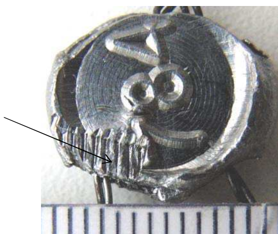
Ил. 4. Поверхность тела пули с лицевой стороны со следами статического давления (отмечены стрелкой)
