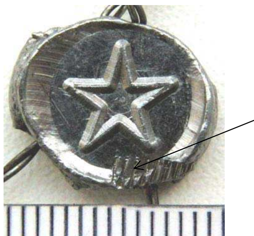
Ил. 5. Поверхность тела пули с обратной стороны со следами статического давления (отмечены стрелкой)
