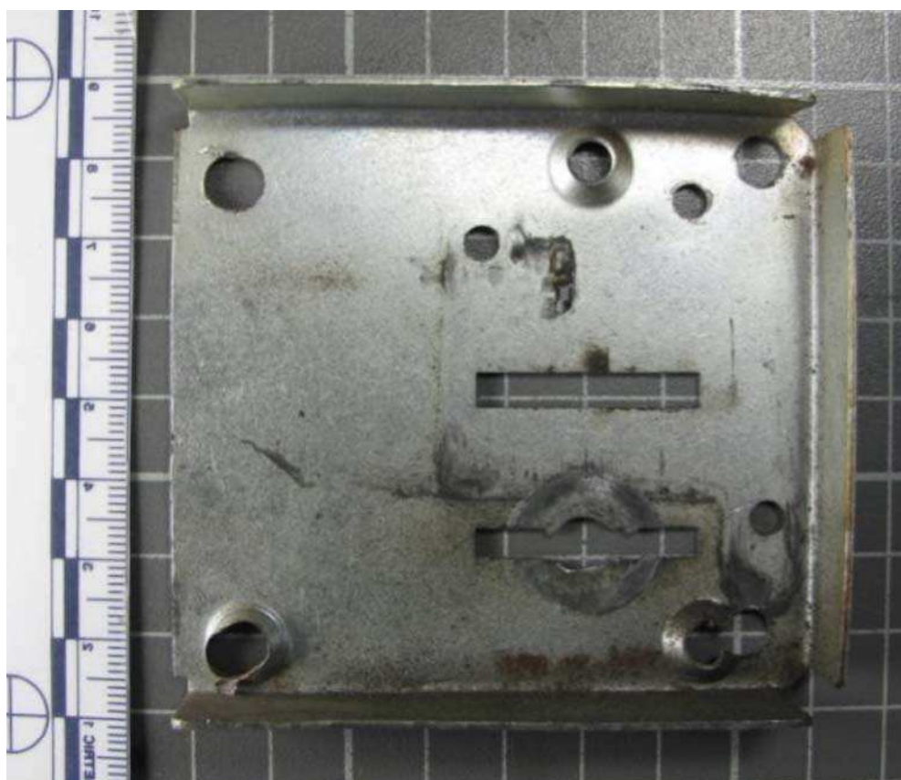
Ил. 8. Внутренняя поверхность крышки замка
