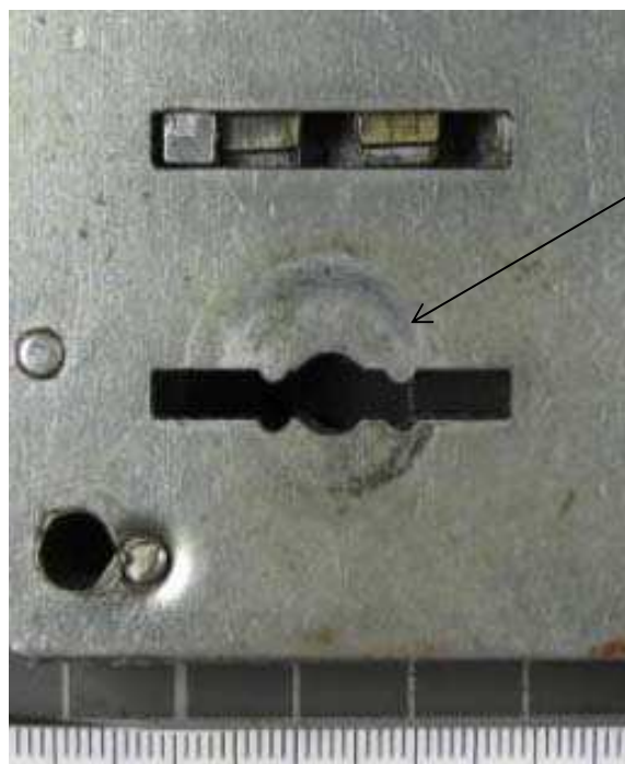
Ил. 3. Концентрические следы на наружной поверхности корпуса замка
