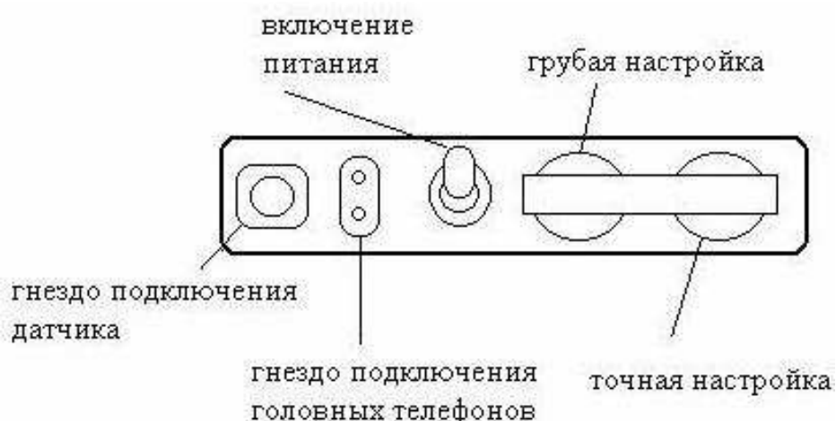
Рис.12. Гнезда коммутации и органы управления прибора «ИМП»
