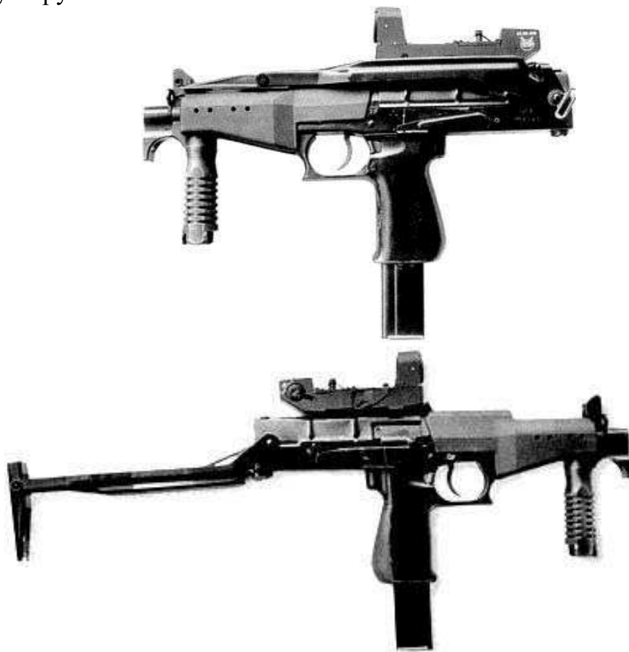
9-мм пистолет-пулемёт СР-2М: справа - плечевой упор откинут.
