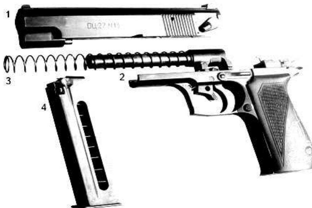
Неполная разборка: 1-затвор, 2-рама, 3-возвратная пружина, 4-магазин, 5-накладки
