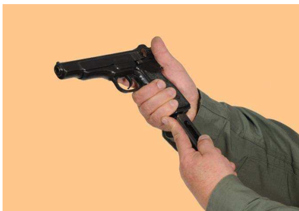
Рис 1.Досылание патрона в патронник в пистолете Ярыгина. а) Вид спереди
