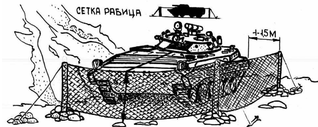
Рис. 12 Защита техники от кумулятивных боеприпасов.
