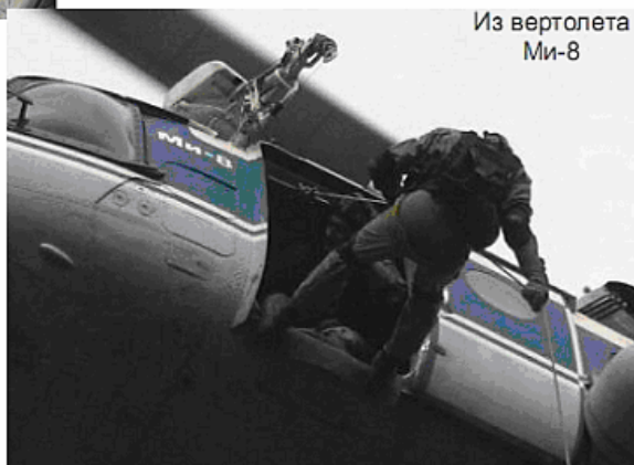
Положение узлов КС-К перед началом движения десантника по шнуру
