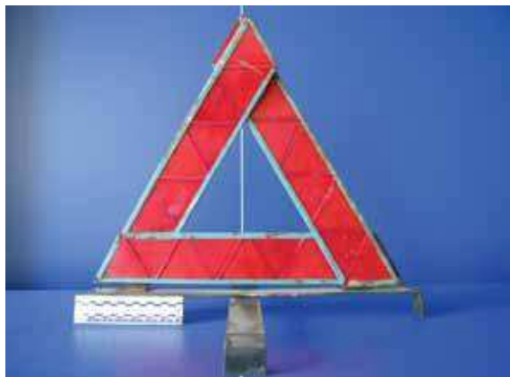
Иллюстрация 1. Знак № 1 – производитель неизвестен (кустарное производство), маркировочных данных и знака официального утверждения не имеет.
