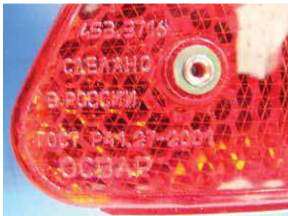
Иллюстрация 7. Маркировка знака № 4 – производитель ОСВАР, «Сделано в России», «453.3716» и «ГОСТ Р 41.27-2001».
