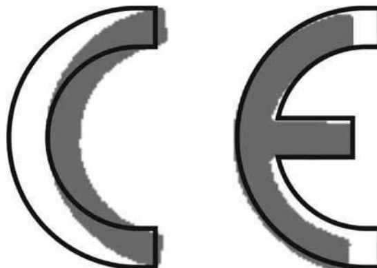
Рис. 2. Совмещение изображений маркировки СЕ на вентиляторе Verloni (показано темным цветом) с эталонным изображением по Решению Совета Европы от 22 июля 1993 г. 93/465/ЕЭС [1] (показано контуром)
