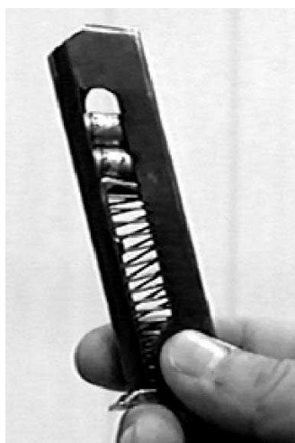
Рисунок 32. – Механическое повреждение магазина
