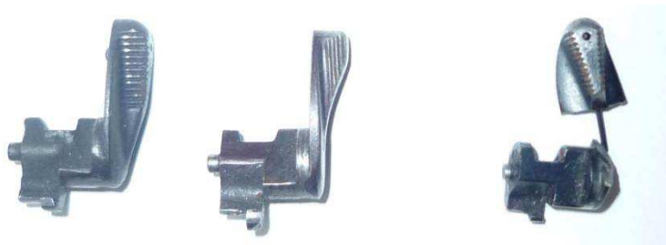
Рисунок 8 – Поломки предохранителя ПМ
