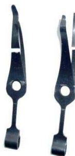
Рисунок 7 – Поломки перьев боевой пружины ПМ
