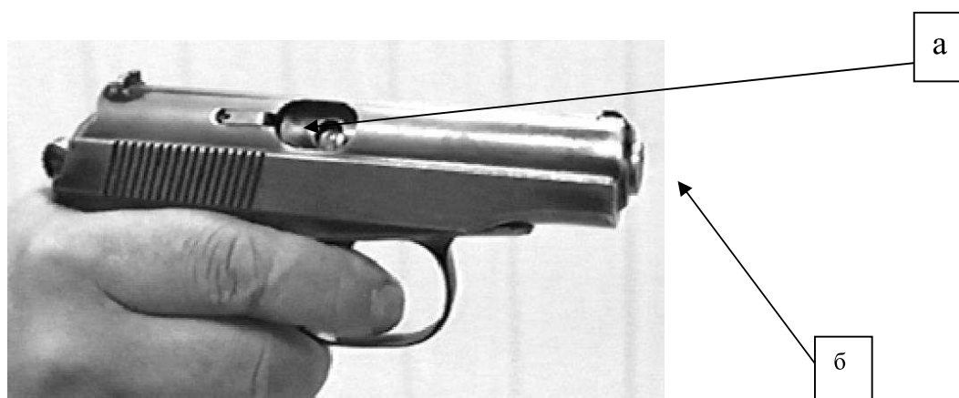
Рис. 35. Внешний вид задержки «недокрытие патрона затвором»: а – выбрасыватель уткнулся в дно гильзы и заскочил в кольцевую проточку, б – затвор не дошел до крайнего переднего положения, ствол виден.
