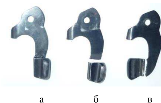
Рисунок 4 – Затворная задержка ПМ: а – исправная; б, в – места поломки
