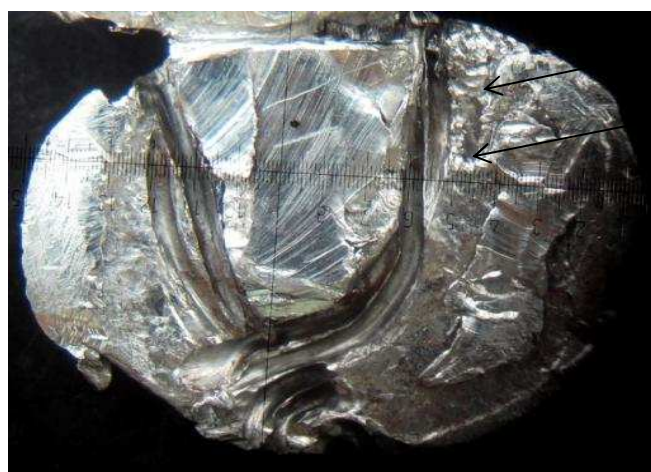
Ил. 9. Внутренняя поверхность камеры пули (оборотная сторона) в разрезе без проволоки с вдавленными следами, совпадающими с положением и конфигурацией фрагмента в виде крючка (отм. 1), и следами скольжения остроконечного предмета (отм. 2)
