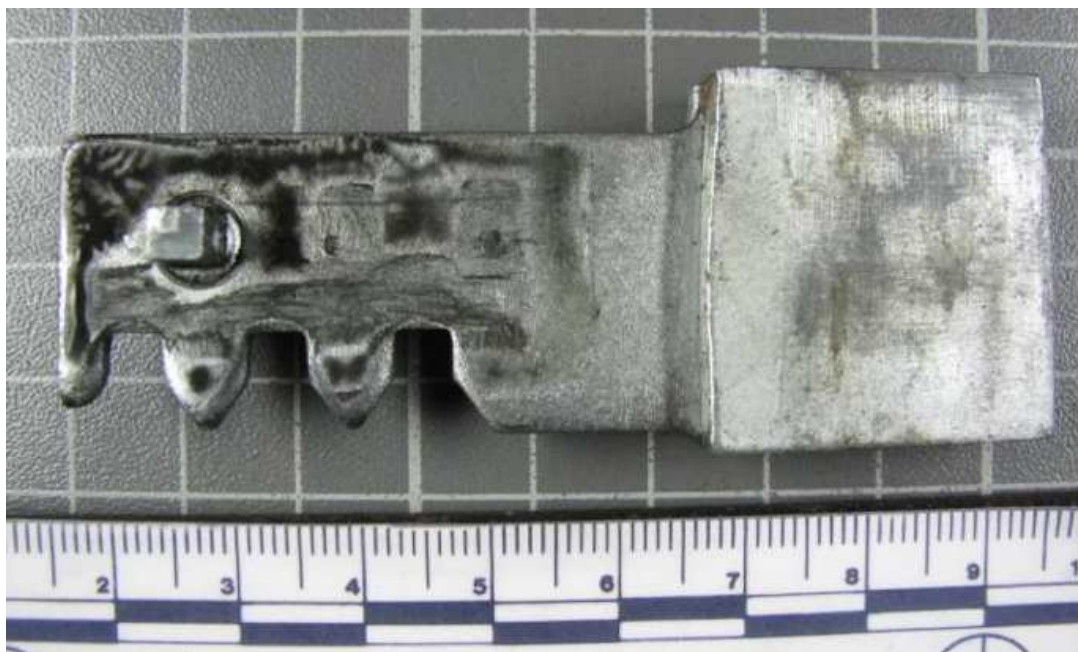
Ил. 9. Засов (вид со стороны корпуса замка)
