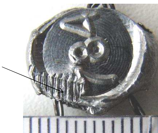
Ил. 4. Поверхность тела пломбы с лицевой стороны со следами статического давления (отмечены стрелкой)
