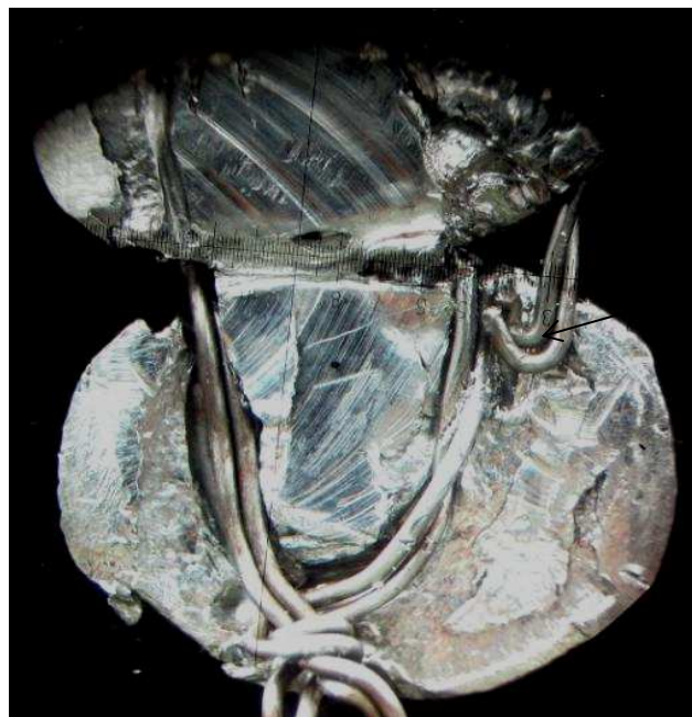
Ил. 8. Тело пули в разрезе с фрагментами проволоки, один из которых загнут в виде крючка (отмечен стрелкой)
