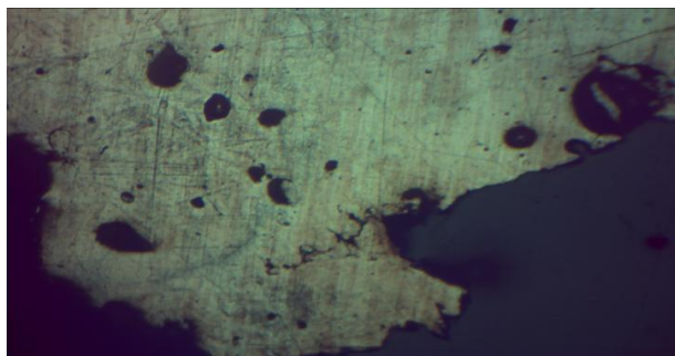
Рис. 5. Зона оплавления проводника после КЗ
