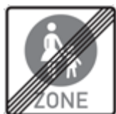
Zeichen 242.2 Ende einer Fußgängerzone
