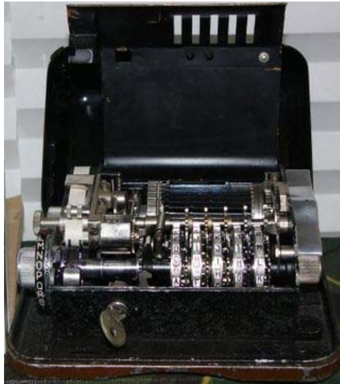
Рис. 12. Шифровальная машина С-36
