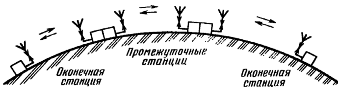
Рис. 4.10. Типичный вид радиолинии
