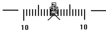
Рис. 95. Определение расстояния до объекта и при помощи шкалы боковых поправок сетки прицела
