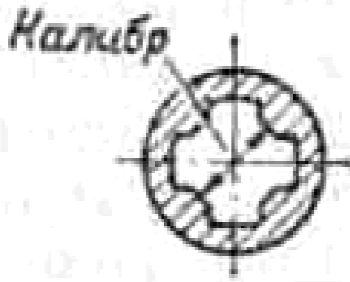
Рис. 15. Сечение канала ствола автомата
