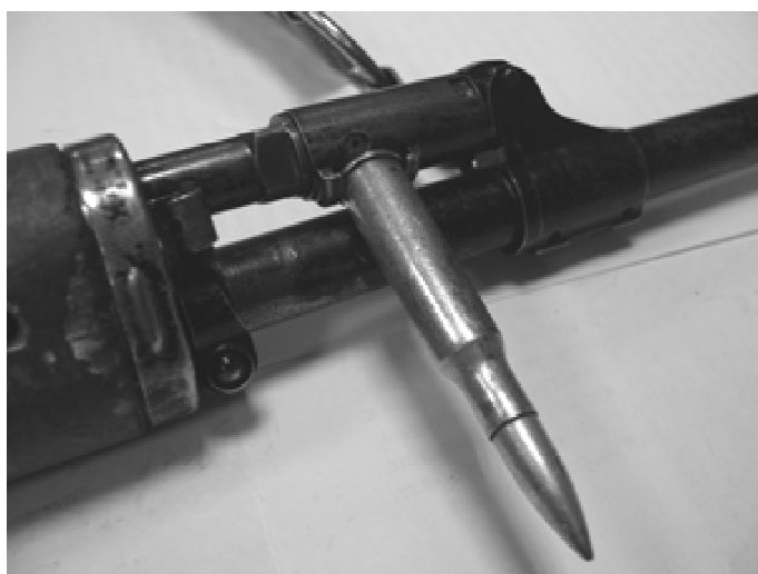
Рис. 61. Перестановка газового регулятора
