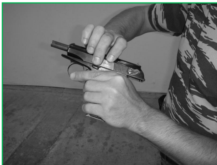
Рис.44. Снятие затвора с затворной задержки. Пистолет находится в слабой руке
