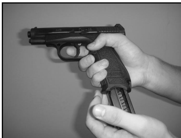
Рис. 12. Извлечение магазина нажатием на кнопку защелку у пистолета ГШ-18
