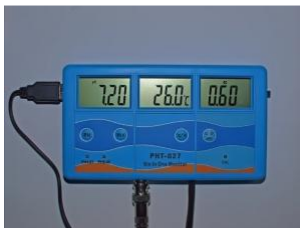
Рис. 15. TDS-метр PHT-027. Измеряет Ph раствора, температуру, электропроводность, концентрацию минеральных солей
