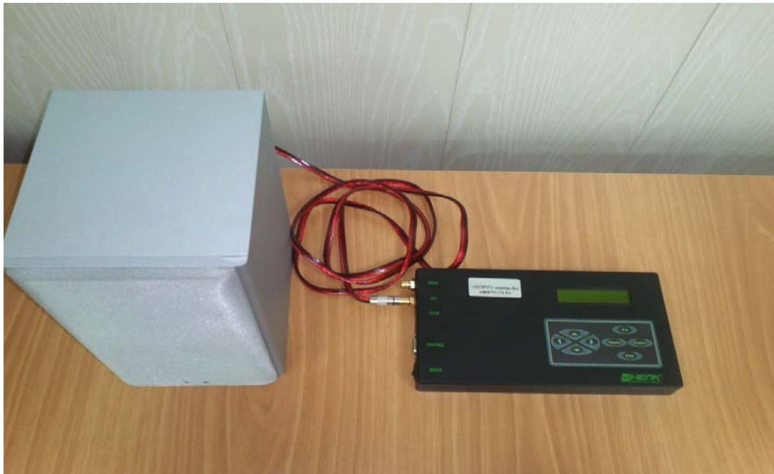
Рис.7. Блок формирования тестовых акустических сигналов с акустической системой.
