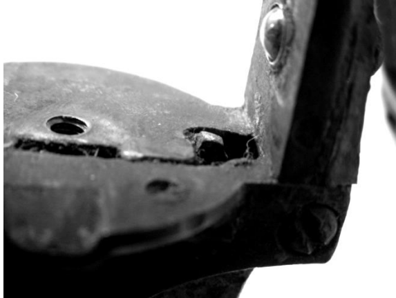
Фото-3. Вид щитка рамки с бойком, не выступающем за её пределы.
