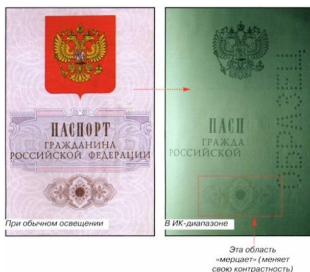
Рис. 7. При исследовании бланка паспорта в инфракрасном диапазоне спектра, на первой и последней страницах наблюдается только часть изображения, видимого при обычном освещении / контролируется с помощью прибора «Ультрамаг-СБВП» в режиме проверки ИК-защиты
