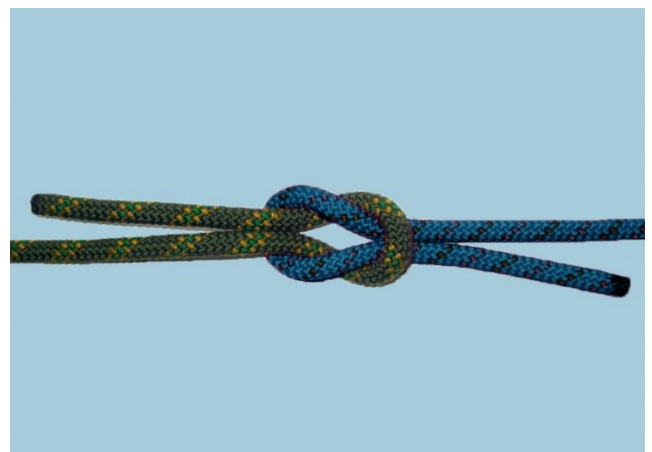
Рис. 22. Порядок связывания верёвок одинакового диаметра «прямым узлом» (узел вяжется концом одной верёвки на петле другой верёвки)
