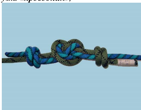
Рис. 13. Порядок связывания веревок одинакового диаметра узлом « встречный проводник »
