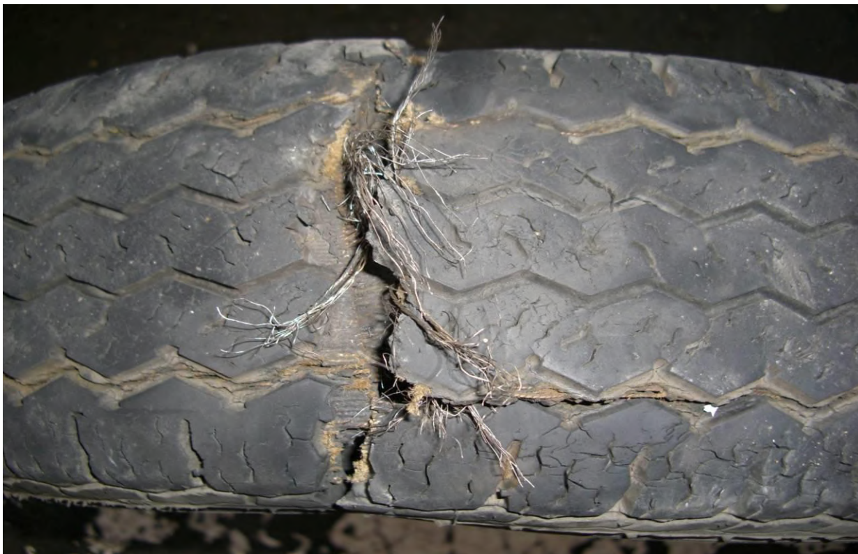
Рис. 22. Разрыв автомобильной шины
