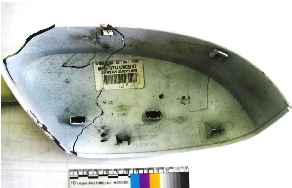
Рис. 2. Внутренняя сторона корпуса зеркала заднего вида от неустановленного транспортного средства
