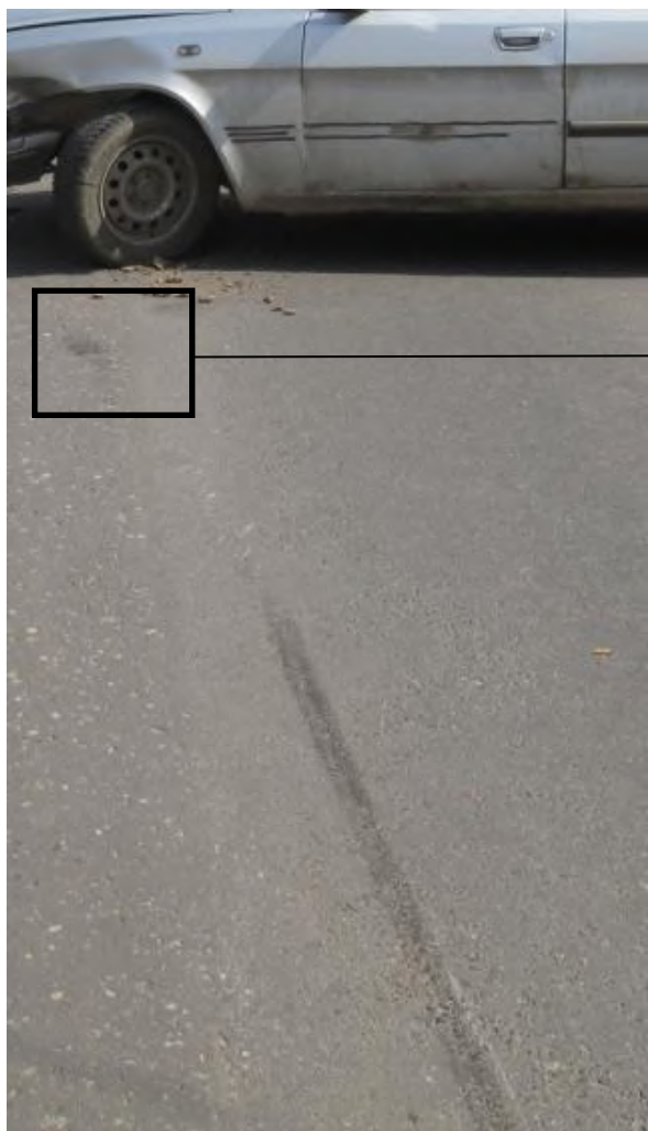
Рис. 7. След торможения протектором мотоцикла
