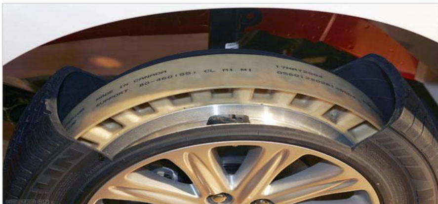
Рис. 3. Автомобильная шина в разрезе, выполненная по технологии Run Flat
