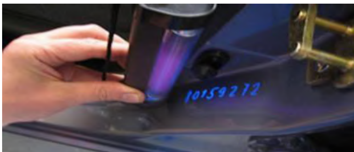
Рис. 13. Элементы системы «Литэкс», нанесенные специальным маркером на часть транспортного средства
