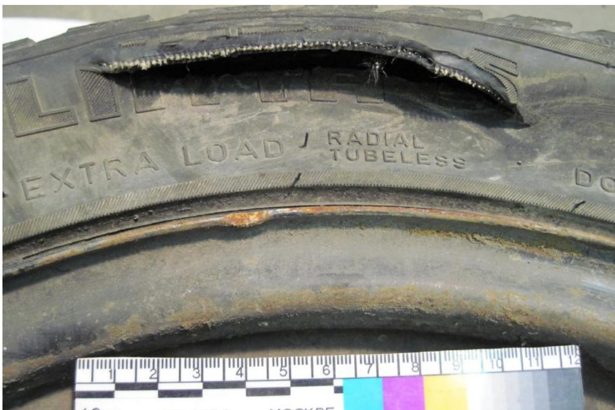
Рис. 25. Повреждение в виде разреза, обнаруженное на исследуемом колесе автомобиля
