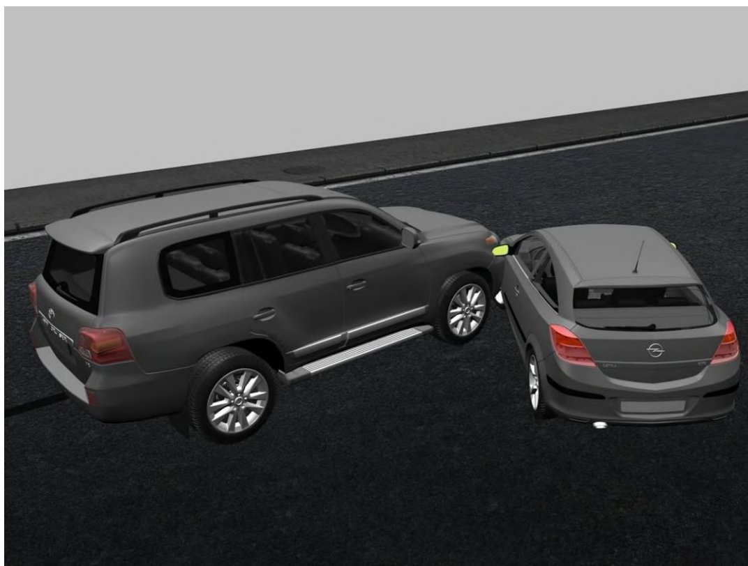
Рис. 10. Моделирование расположения транспортных средств при столкновении (при условии, что в момент совершения маневра расстояние от «Опель Астра» до тротуара составляло 2,7 м)
