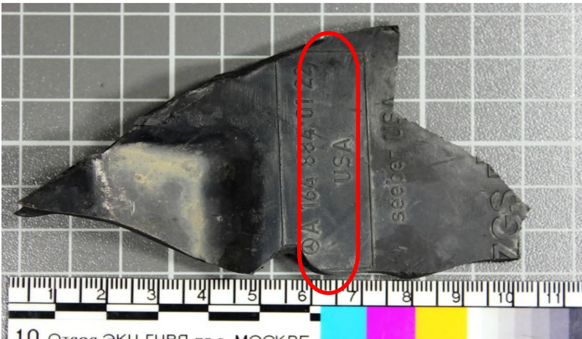
Рис. 10. Внутренняя сторона полимерной части, отделившейся от неустановленного транспортного средства (контурными линиями выделен каталожный номер)
