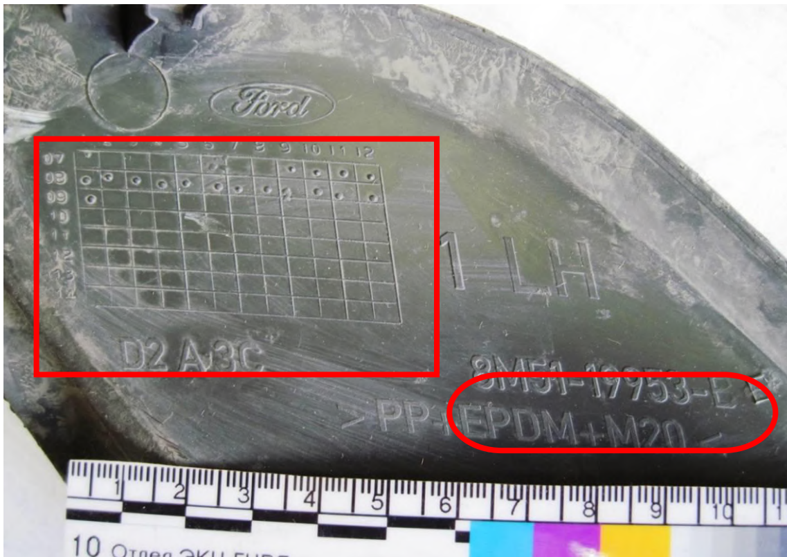
Рис. 1. Внутренняя сторона корпуса зеркала заднего вида неустановленного транспортного средства (контурными линиями выделены обозначения года изготовления части ТС и каталожный номер)
