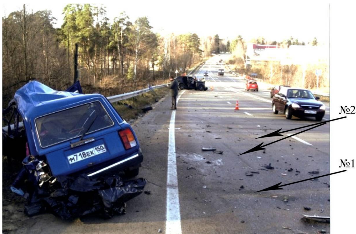
Рис. 2. Место столкновения транспортных средств (стрелками указано расположение и наличие следов места столкновения)
