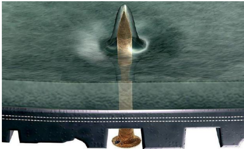
Рис. 5. Схематическое изображение автомобильной шины, выполненной по технологии S-Concept
