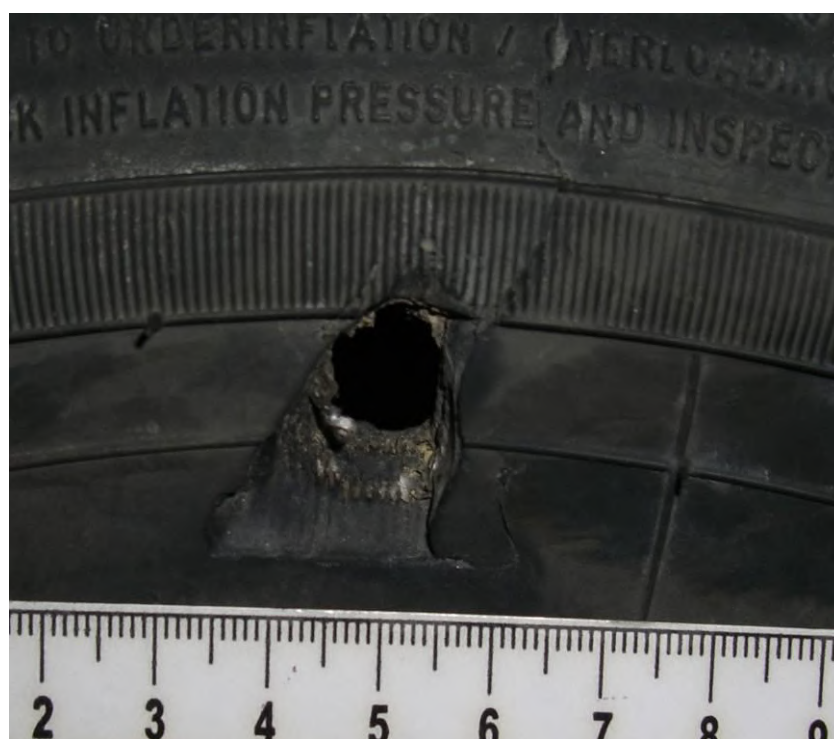
Рис. 18, 19. Пробои на автомобильной шине
