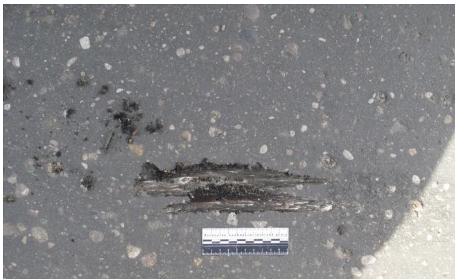
Рис. 8. Объемный след (динамические трассы) от выступающих частей мотоцикла
