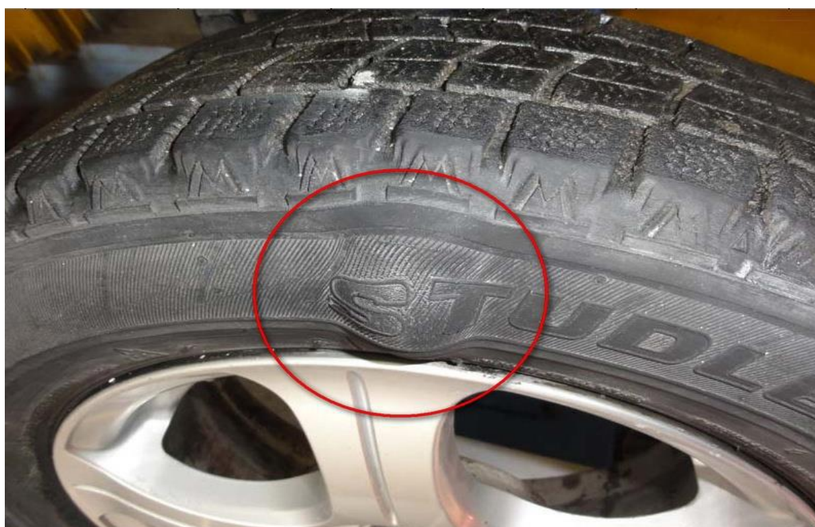
Рис. 17. Вздутие (кила) на автомобильной шине
