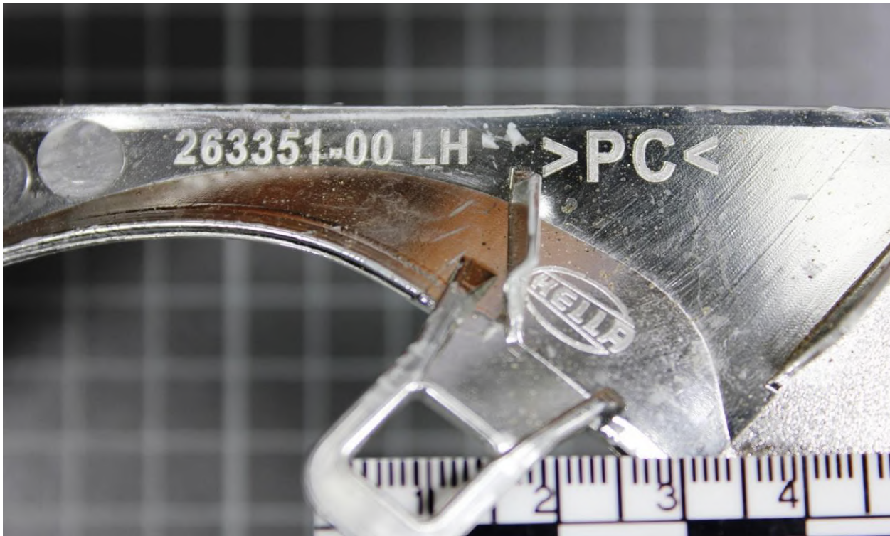
Рис. 3. Фрагмент светоотражательного элемента фары, неустановленного ТС с артикульными номерами
