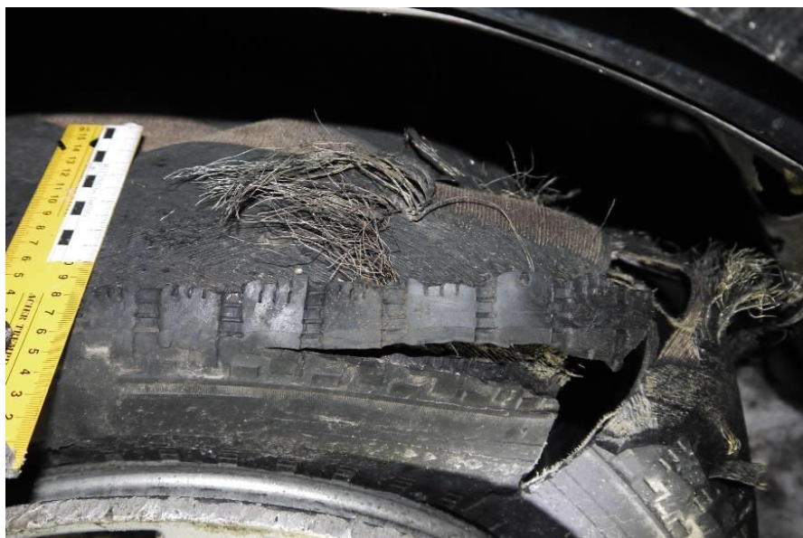
Рис. 2. Повреждения задней правой шины а/м Land Rover Discovery 3
