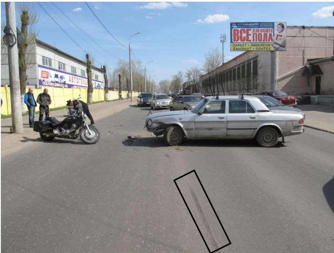
Рис. 3. Общий вид места столкновения транспортных средств (прямоугольником выделены следы торможения протектора колес мотоцикла)
