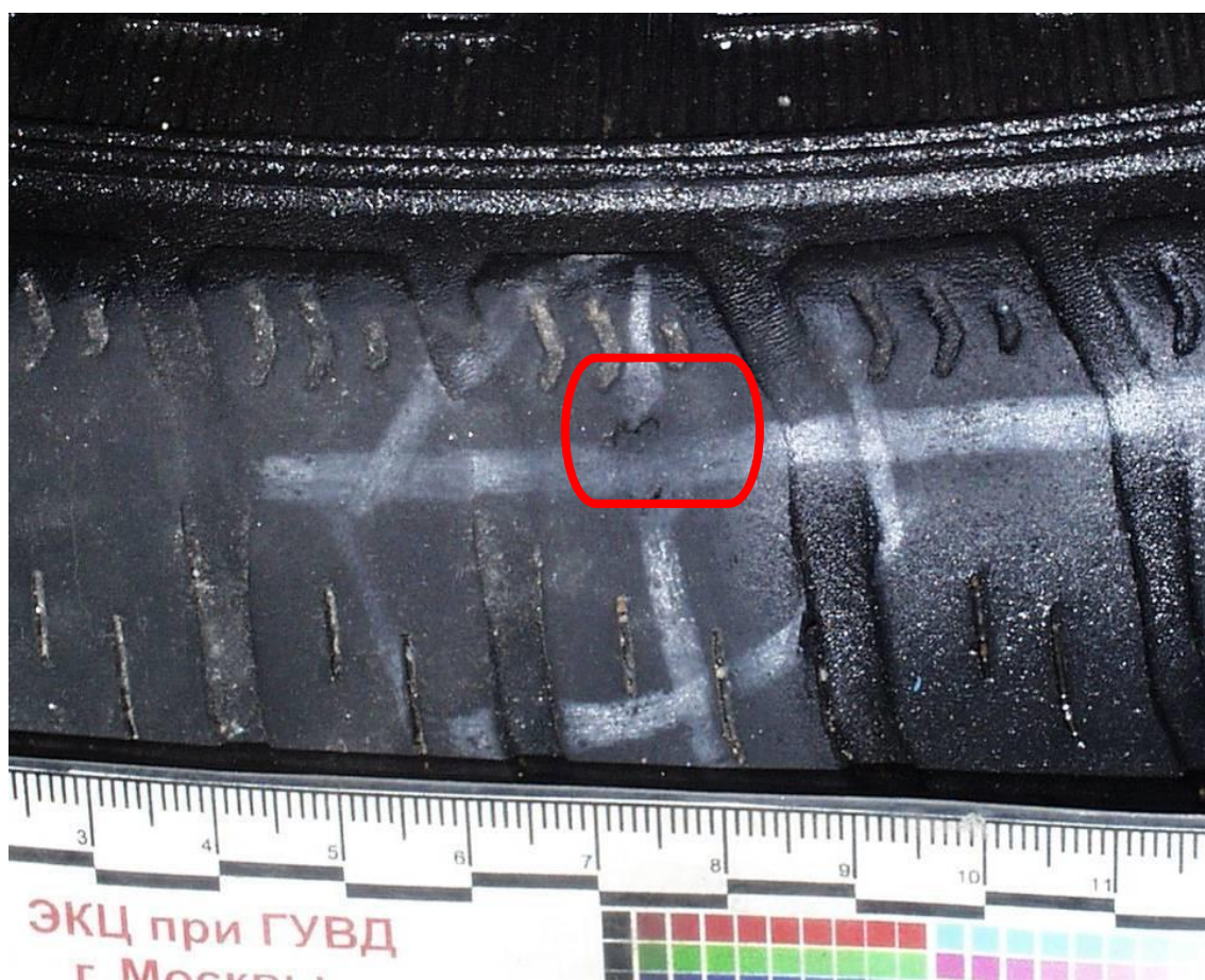
Рис. 21. Прокол автомобильной шины
