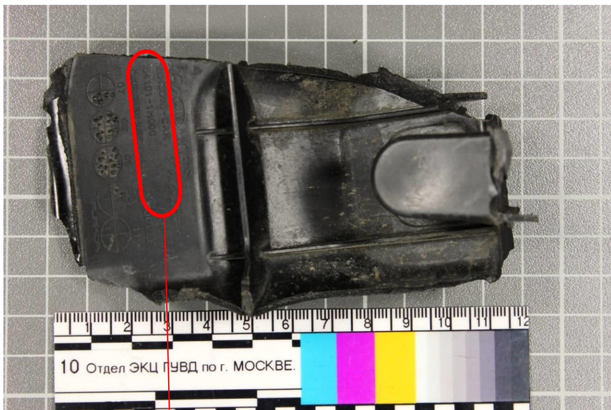
Рис. 5. Внутренняя сторона полимерной части неустановленного транспортного средства (контурными линиями выделен каталожный номер части ТС)
