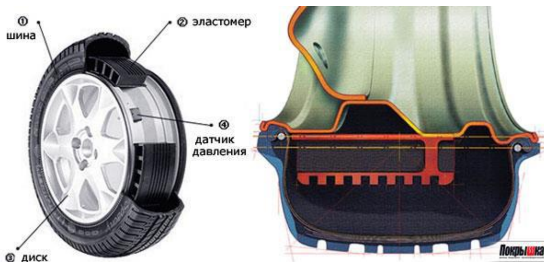
Рис. 4. Схематическое изображение автомобильной шины, выполненной по технологии PAX System
