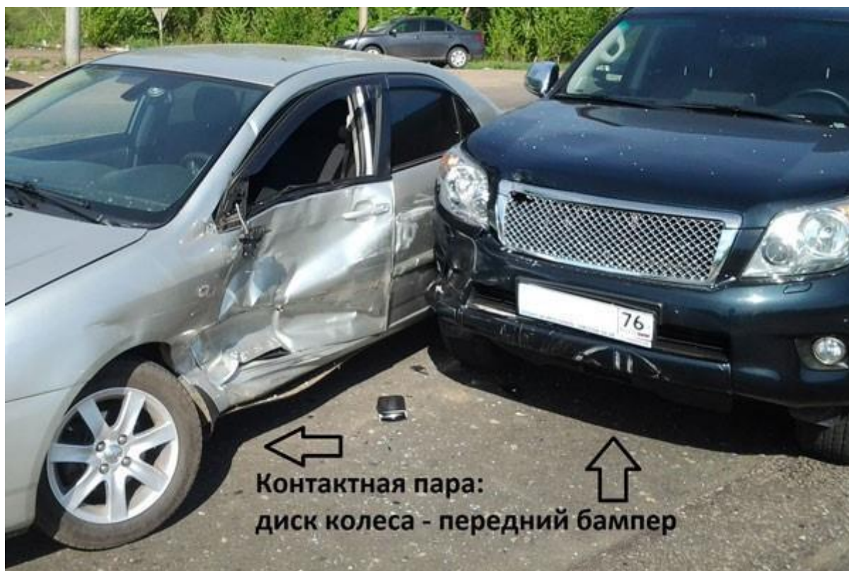
Рис. 16. Следы контакта от столкновения на транспортных средствах (стрелками обозначены «парные повреждения»)
