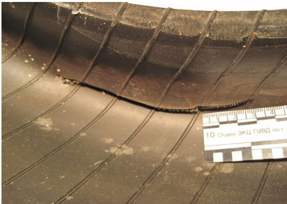
Рис. 26. Повреждение в виде разреза, обнаруженное на исследуемом колесе автомобиля (вид с оборотной стороны после демонтажа шины)
