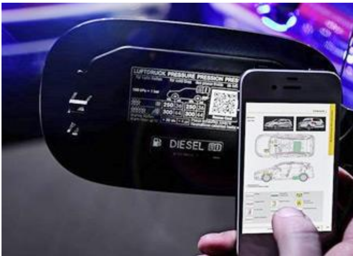
Рис. 27. Маркирование QR-кодом внутренней поверхности крышки бензобака автомобиля «Мерседес»
