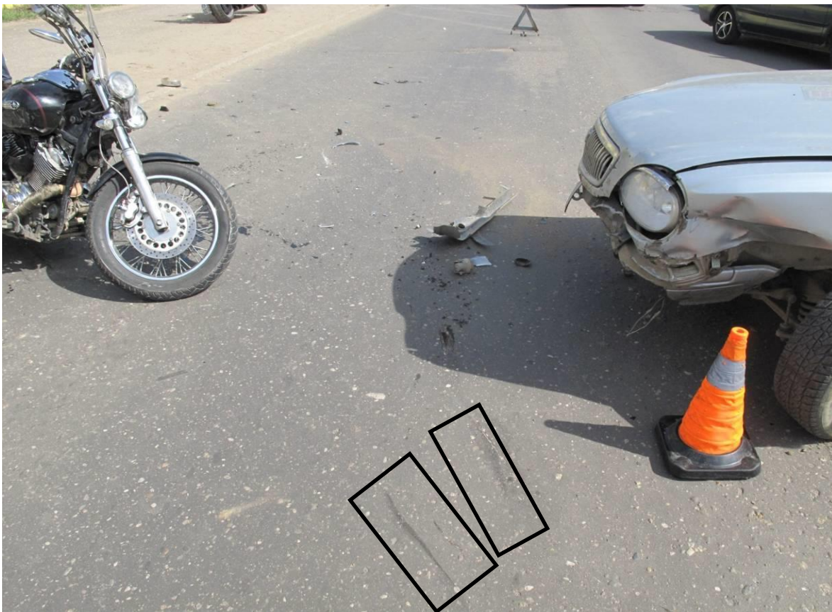
Рис. 4. Следы трения от выступающих боковых частей мотоцикла
