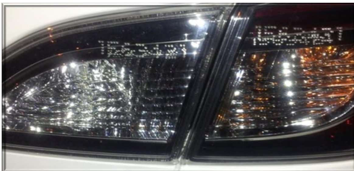
Рис. 12. Элементы системы «Литэкс», нанесенные ударным способом кернением на линзы передней фары транспортного средства
