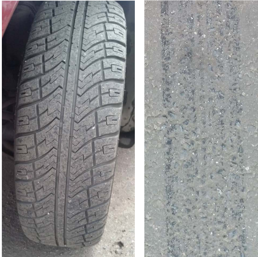
Рис. 4. Шина автомобиля и след полученный в результате торможения
