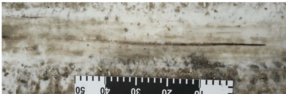
Рис. 8. След колеса автомобиля, оставленный невращающимся заблокированным колесом
