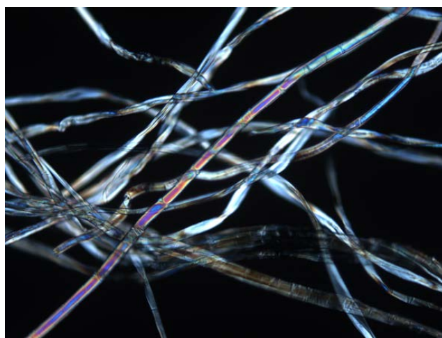
Рис. 2. Волокна образца – 40 % Organic Cotton +60% Hemp. Хлопковые и лубяные волокна
