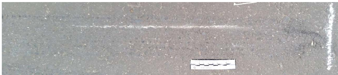
Рис. 3. След торможения на ЮЗ на асфальтовом покрытии полученный в ходе эксперимента
