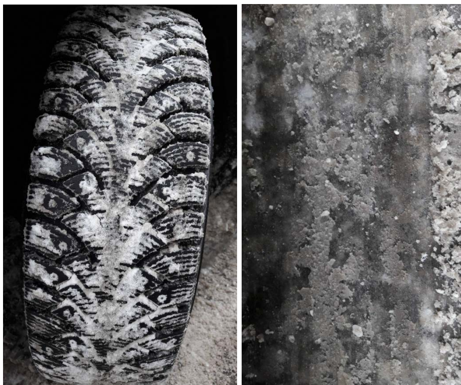
Рис. 6. Шина и след торможения на юз от нее
