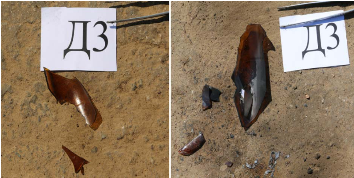
Рис. 2. Осколки БЗС. Слева осколок находившийся вне зоны горения, справа – в зоне горения
