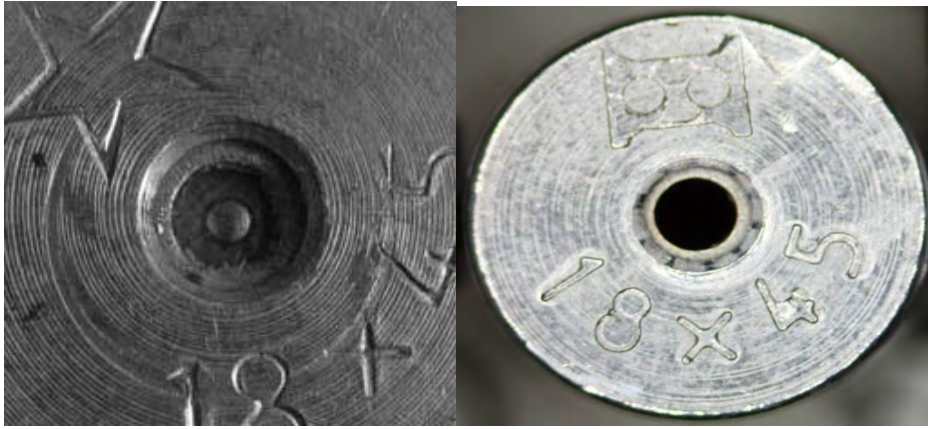
Рис. 7. Слева – увеличенный след в виде концентрического круга от узла контакта бесствольного пистолета мод. МР-461 «Стражник» кал. 18 × 45мм; справа – донная часть гильзы с маркировочными обозначениями, а также следом от фиксатора патронов (пистолет мод. «Оса» «ПБ-4М» кал. 18 × 45мм)
