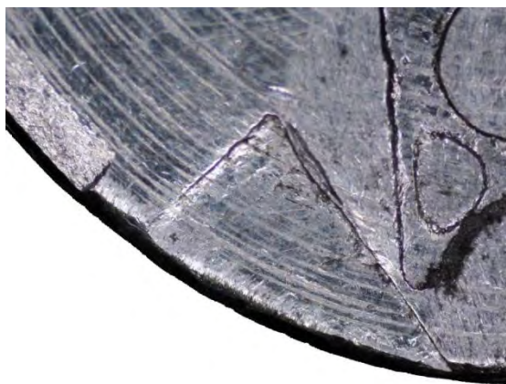
Рис. 5. Увеличенный след треугольной формы от фиксатора патронов
