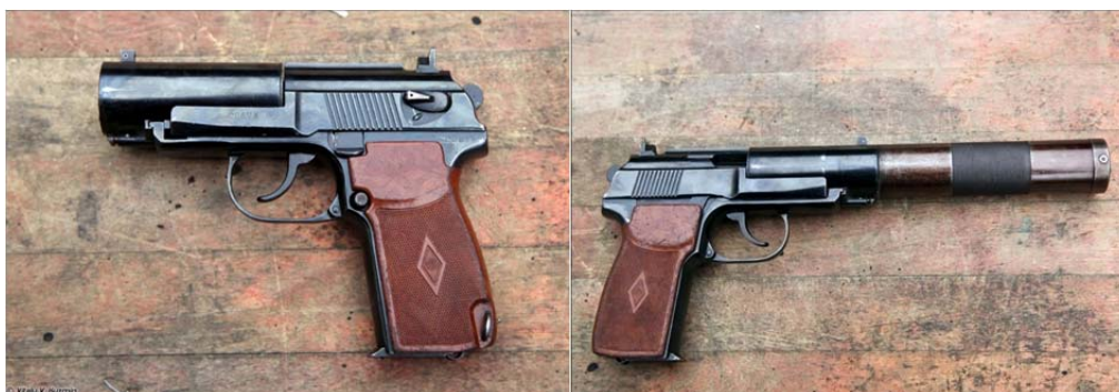
Рис. 25. а) Пистолет бесшумный ПБ (6П9) б) Пистолет ПБ с присоединенной передней частью ПБС
