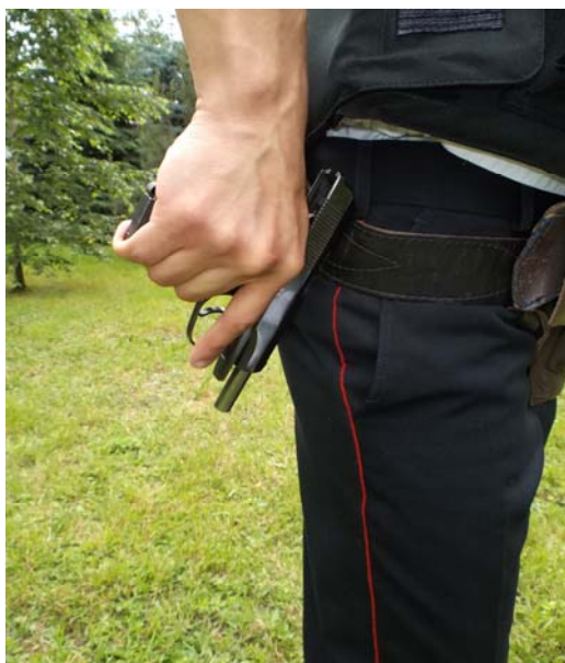
Рис. 14. Досылание патрона в патронник при помощи фиксирования целика затвора о поясной ремень
