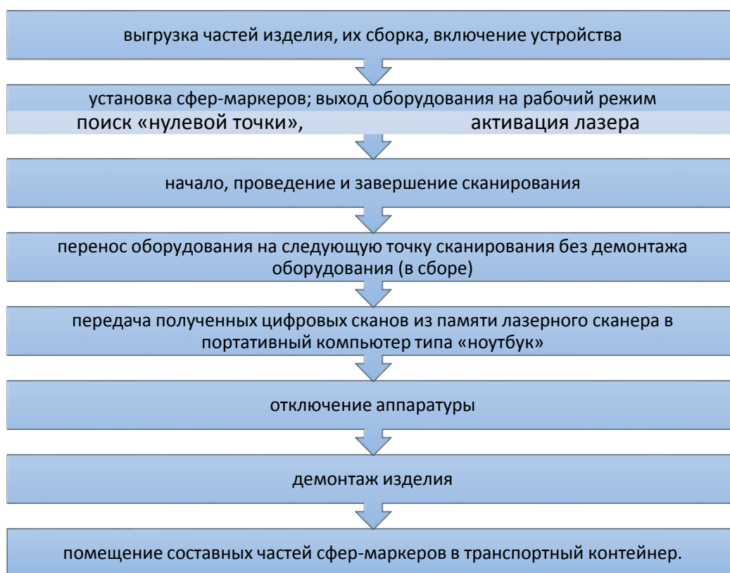
Рисунок 2.2 – Последовательность действий при использовании средств 3D фиксации места ДТП
