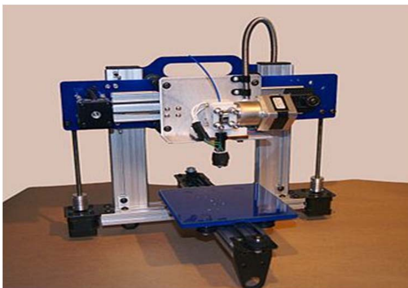
Рис.№1. 3D-принтер — как периферийное устройство, использующее метод послойного создания физического объекта по цифровой 3D-модели.
