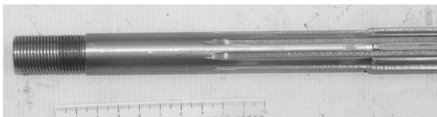
Рис.3. Самодельный ствол винтовки.
