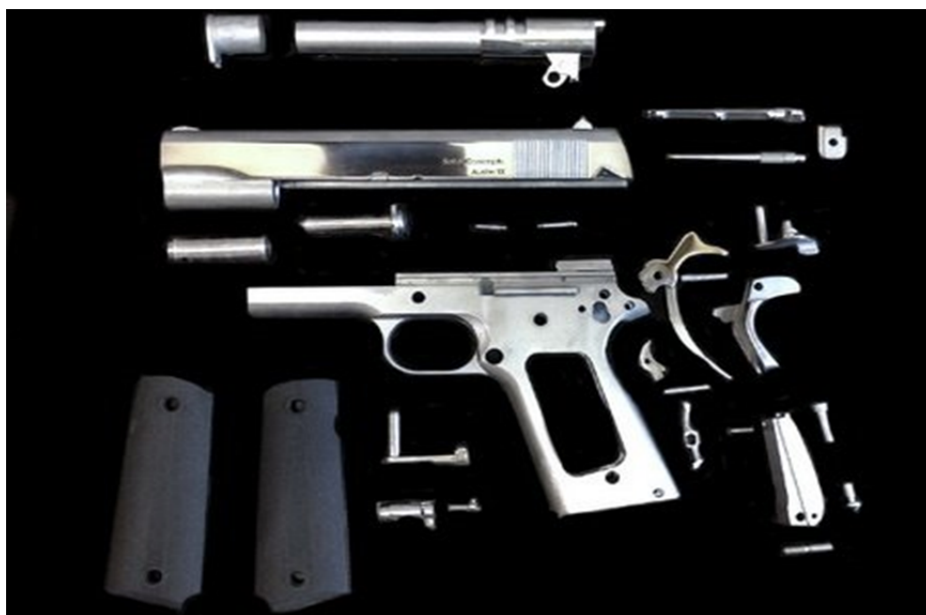
Рис № 2. Реплика частей и деталей американского пистолета «Кольт» калибра 11,43 мм, изготовленного с использованием принтера 3D – печати.
