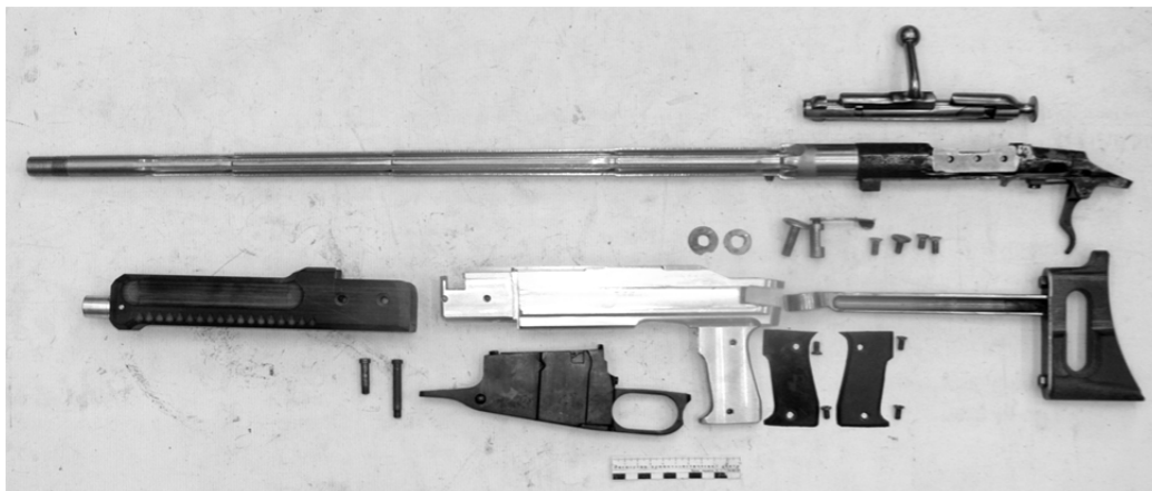
Рис.2. Самодельная винтовка в разобранном виде.
