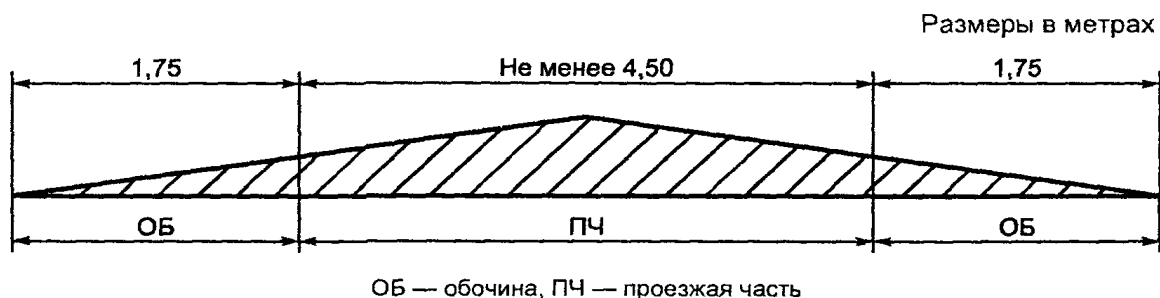
Рисунок 12 — Поперечные профили автомобильных дорог категории V
