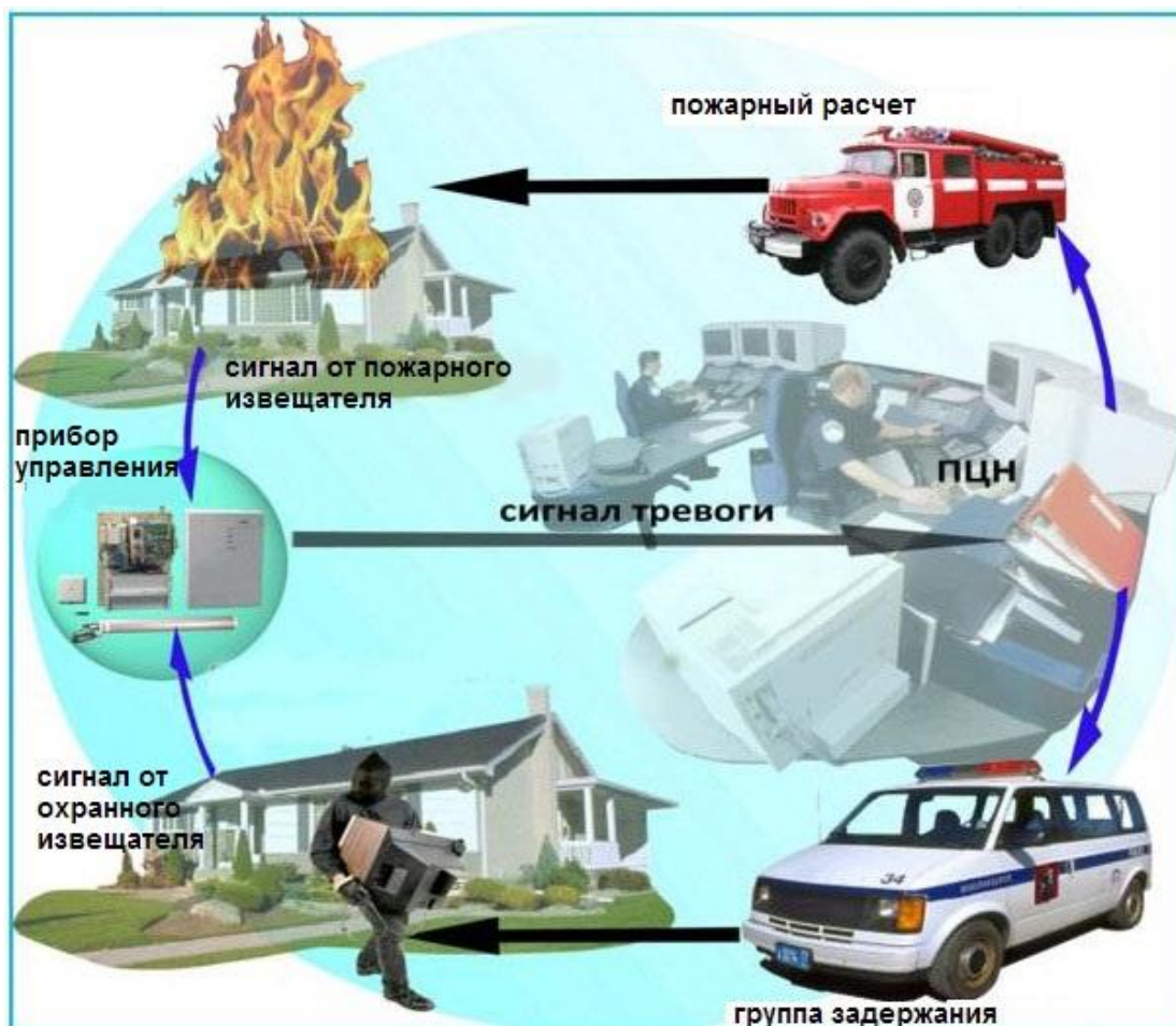
Рис. 5.1. Схема охранно-пожарной сигнализации централизованного типа
