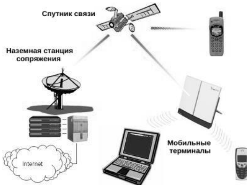
Рис.4.4. Структурная схема спутниковой системы связи
