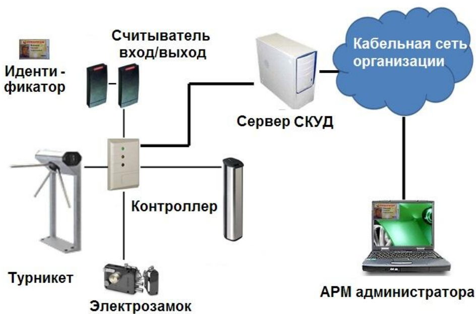
Рис. 5.3. Схема сетевой СКУД
