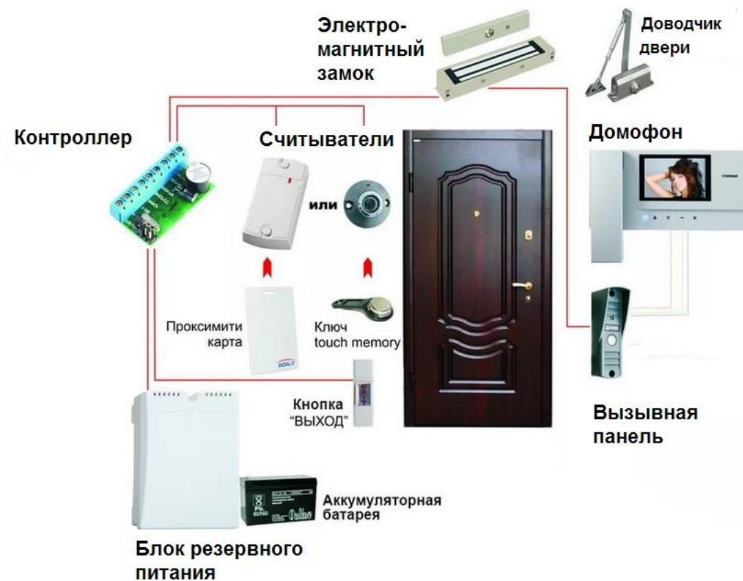
Рис. 5.2. Схема автономной СКУД
