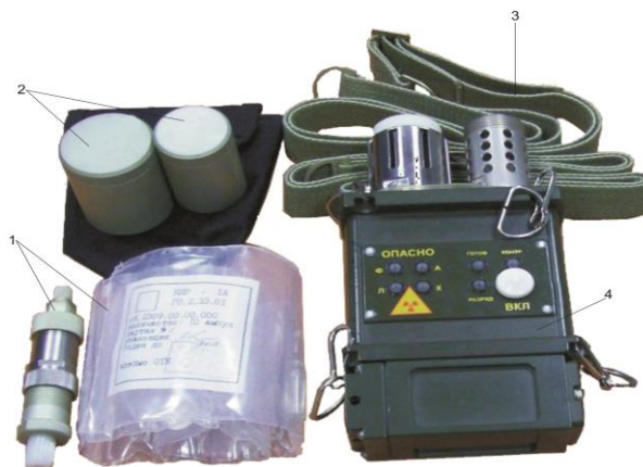
Рис. 5.8. Газосигнализатор войсковой автоматический ГСА-3: 1 – комплект ЗИП-О; 2 – колпаки; 3 – ремни; 4 – блок индикации
