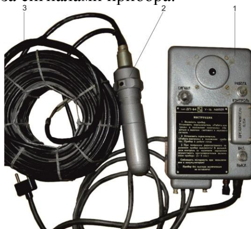
Рис 5.1. Индикатор-сигнализатор ДП-64: 1 – пульт сигнализации; 2 – датчик; 3 – кабель
