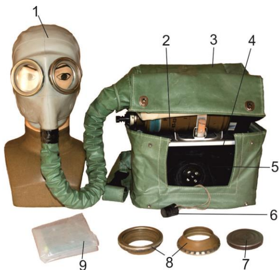
Рис. 2.1. Изолирующий дыхательный аппарат ИП-4: 1 – шлем-маска ШИП-2б (к); 2 – регенеративный патрон РП-4; 3 – сумка; 4 – каркас; 5 – дыхательный мешок; 6 – пробка; 7 – незапотевающие пленки; 8 – накладные утеплительные манжеты НМУ-1М; 9 – мешок для хранения
