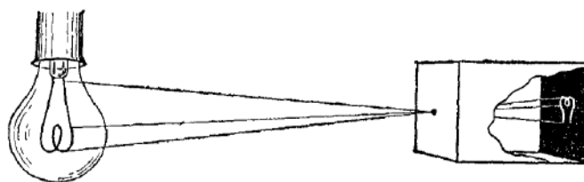
Рис. 7. Изображение предмета в «дырочной камере»
