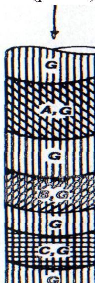
Рис. 2. Проявительная хроматография: участок колонки со сложившимся распределением хроматографических зон
