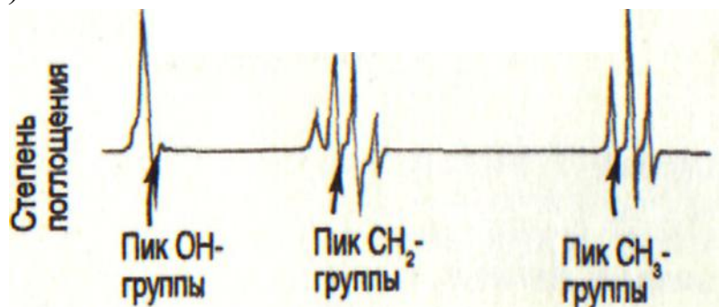
Рис. 7. Спектр ядерного магнитного резонанса этанола ( \text{CH}_3\text{CH}_2\text{OH} )
