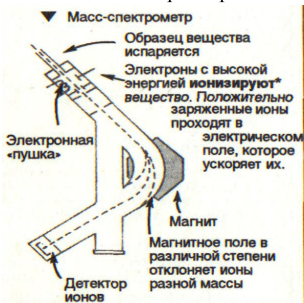
Рис. 5. Принципиальная схема масс – спектрометра
