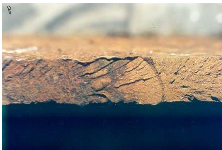
Рис. 11. Усталостный излом рельса Рис. 12. Усталостная трещина
