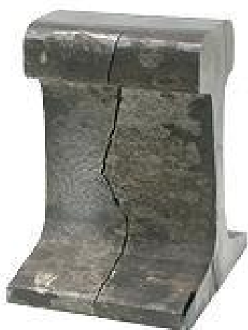
Рис. 11. Усталостный излом рельса Рис. 12. Усталостная трещина
