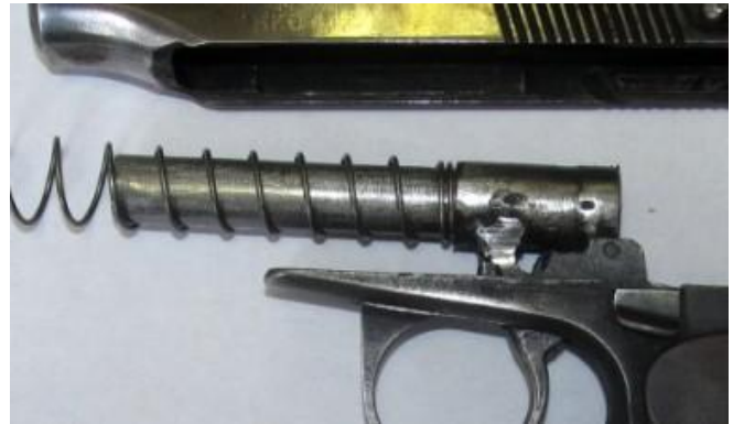
Фото 2. Следы замены ствола пистолета модели ИЖ-79
