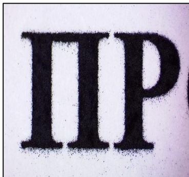
Рис. 9 Увеличенное изображение фрагмента текста, выполненного электрофотографическим способом с помощью монохромного печатающего устройства
