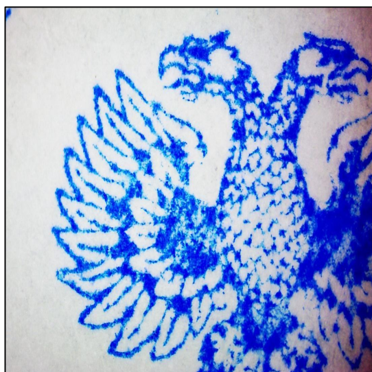
Рис. 14, 15 Увеличенные изображения фрагментов оттисков удостоверительных печатных форм, изготовленных способом лазерного гравирования
