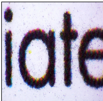
Рис. 10 Увеличенное изображение фрагмента текста, выполненного электрофотографическим способом с помощью цветного печатающего устройства
