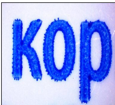
Рис. 3 Увеличенное изображение фрагмента текста, нанесенного способом высокой (флексографской) печати на полимерной пленке
