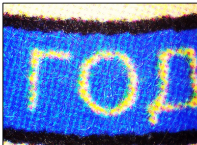
Рис. 11 Фрагмент цветной иллюстрации, выполненной электрофотографическим способом с помощью цветного печатающего устройства
