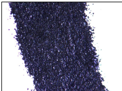
Рис. 12 Микроструктура штриха изображения, выполненного электрофотографическим способом с помощью монохромного печатающего устройства
