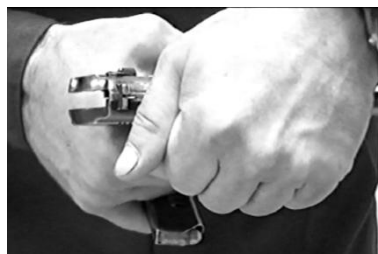
Рис. 31. Порядок устранения задержки «прихват (ущемление) гильзы (патрона) затвором»: а) извлечь магазин из основания рукоятки пистолета; б) вложить магазин под мизинец и безымянный палец; в) отвести затвор в заднее положение, стараясь не закрыть окно выбрасывателя; г) извлечь прихваченную гильзу (патрон) в руку
