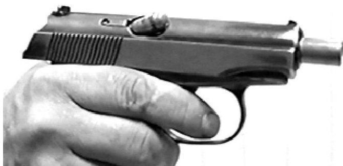
Рис. 30. Внешний вид задержки «прихват (ущемление) гильзы затвором»
