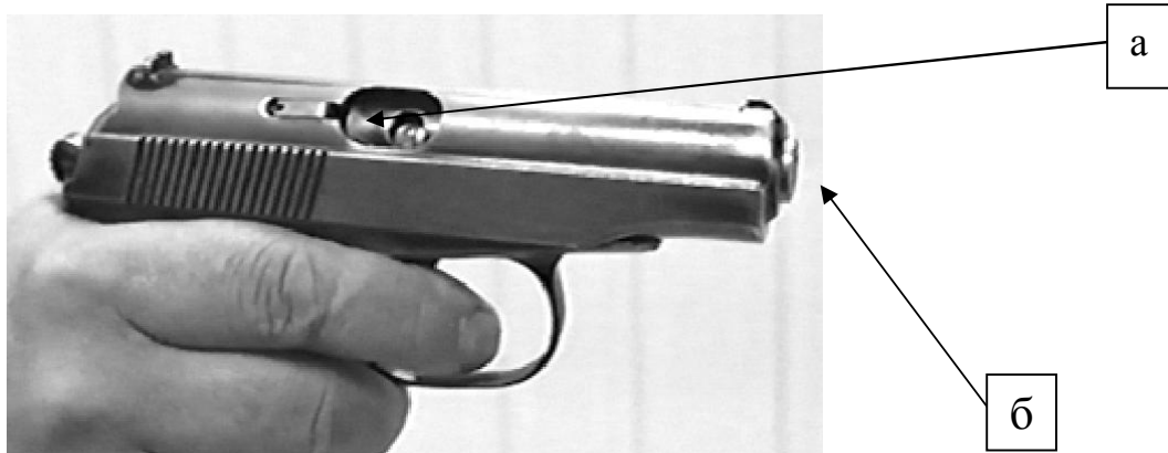
Рис. 28. Внешний вид задержки «недокрытие патрона затвором»: а – выбрасыватель уткнулся в дно гильзы и заскочил в кольцевую проточку, б – затвор не дошел до крайнего переднего положения, ствол виден
