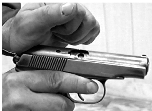
Рис. 29. Устранение задержки «недокрытие патрона затвором»
