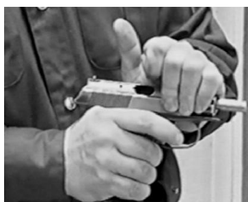
Рис. 24. Способы перезаряжания пистолета: а – за переднюю часть затвора, б – за заднюю часть затвора
