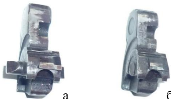
Рис. 20. Курок ПМ: а – исправный, б – с поломкой цапфы
