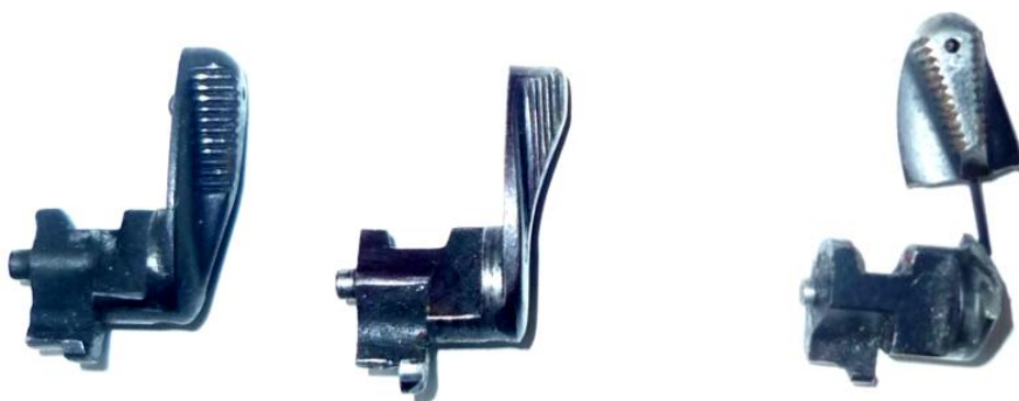
Рис. 22. Поломки предохранителя ПМ
