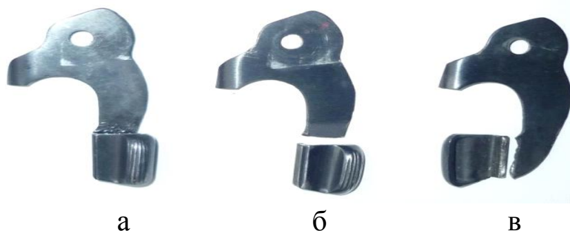
Рис. 18. Затворная задержка ПМ: а – исправная; б, в – места поломки
