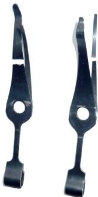
Рис. 21. Поломки перьев боевой пружины ПМ
