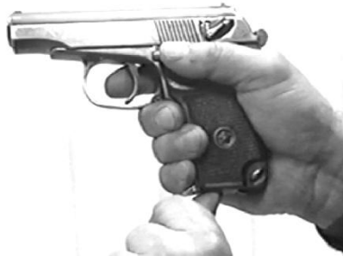
Рис. 27. Фиксация магазина в основании рукоятки защелкой боевой пружины
