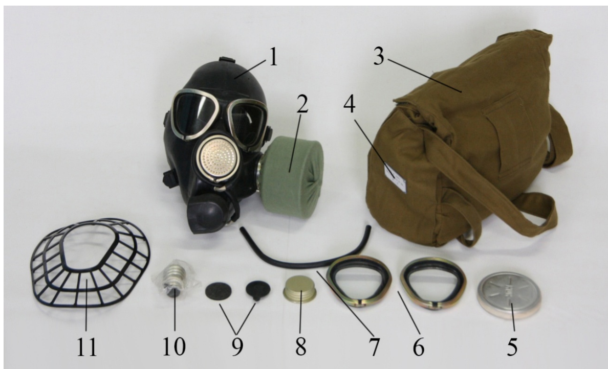
Рис. 4. Устройство противогаза ПМК
