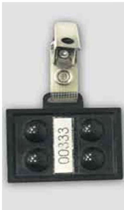
Рис. 5.1. Внешний вид индивидуального дозиметра ДТЛ
