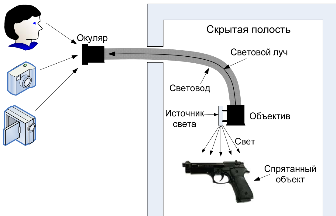
Рис. 1.3. Типовая схема эндоскопа
