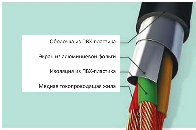
Рис. 4. Структура электрических кабелей
