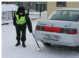
Фото 136. Осмотр нижнего подбагажного пространства автотранспортного средства
