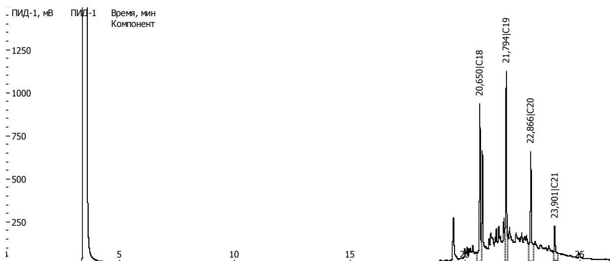
Рисунок 2.5. Хроматограмма испарённого дизельного топлива
