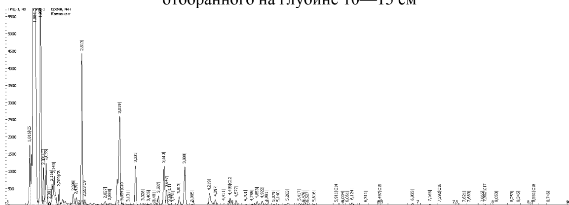
Рисунок 3.14. Хроматограмма экстракта бензина с образца песчаной почвы, отобранного на глубине 5—10 см
