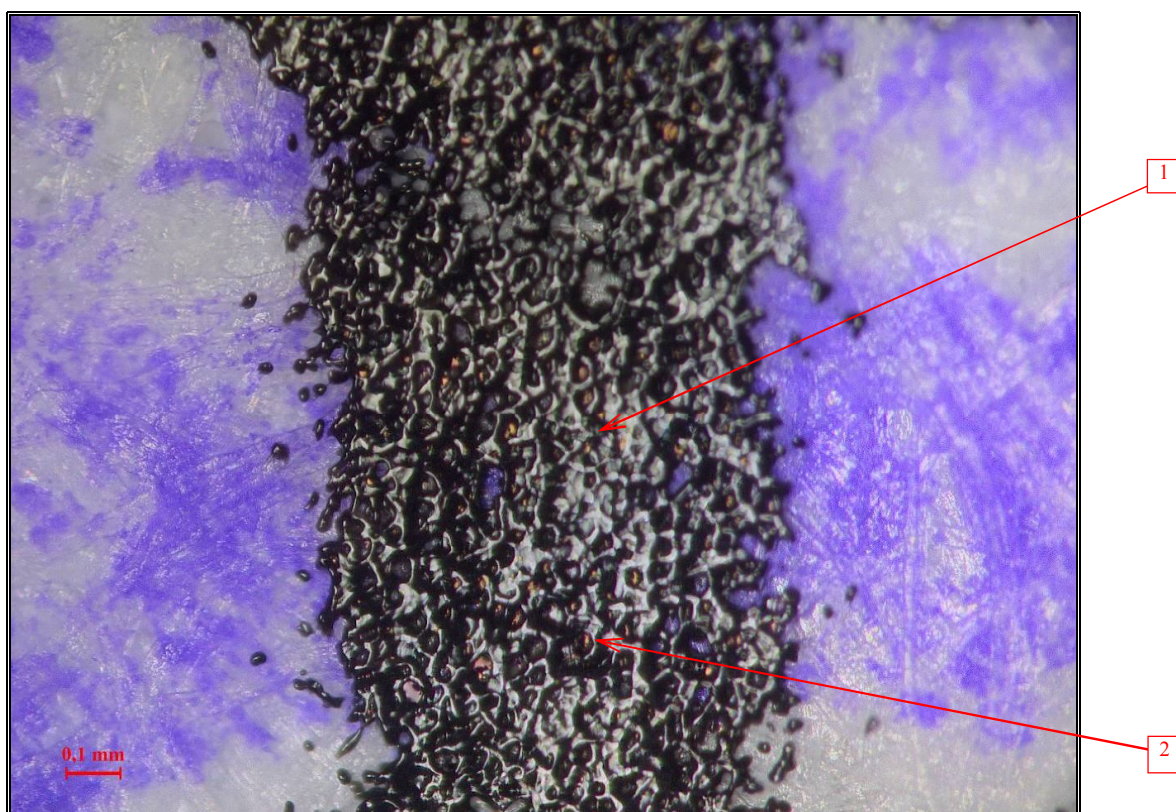
Ил. 3. Увеличенное изображение участка пересечения штриха печатного текста – вертикального элемента буквы «в» в слове «Овечкин» и штриха оттиска печати от имени ТОО «ТЕХНОФОН» – кавычек после слова «ТЕХНОФОН»
