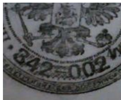
Ил. 6. Первоначальное содержание числа в оттиске гербовой печати на странице 2 паспорта, выявленное в инфракрасных лучах
