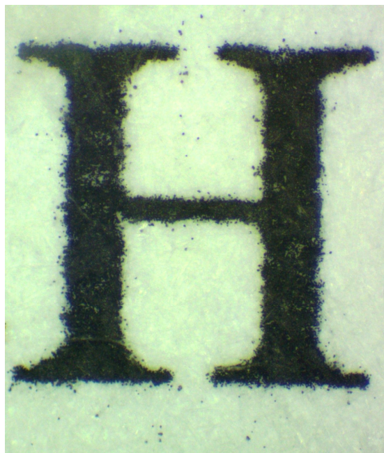
Ил. 4. Увеличенное изображение буквы из фрагмента текста заключения с признаками электрофотографического способа нанесения
