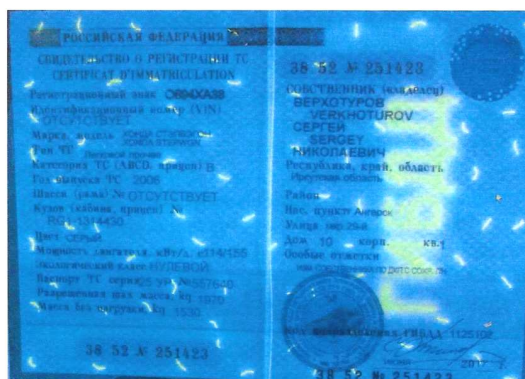
Ил. 6. Люминесценция бланка СТС в ультрафиолетовых лучах
