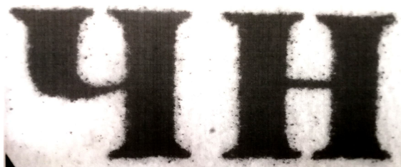
Ил. 3. Увеличенное изображение фрагмента текста справки с признаками электрофотографической печати
