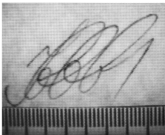
Ил. 6. Увеличенное изображение исследуемой подписи в отраженных инфракрасных лучах, полученное с экрана прибора Ultramag C6
