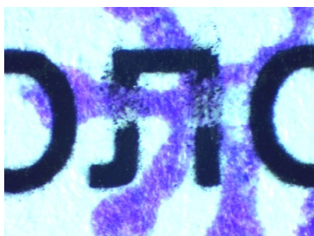
Ил. 5. Наличие красящего вещества под слоем удаленного тонера
